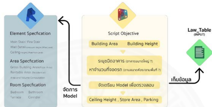
ภาพที่ 3.7 แผนภาพอธิบายสคริปต์การเตรียมแบบจำลอง (Prepare)
