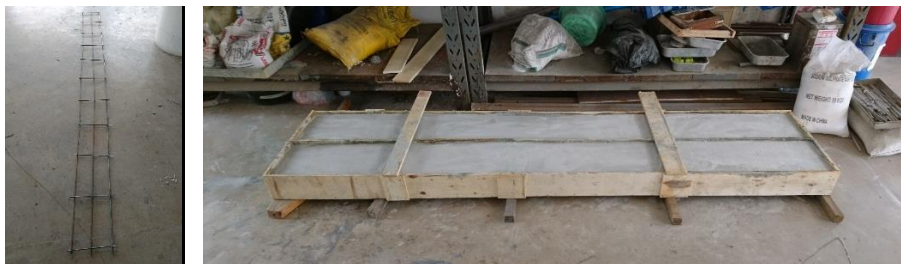
ภาพที่ 3.23 การเตรียมตัวอย่างทดสอบกำลังรับแรงดัดไฟ 3 ลำเสริมแรงรวมมอร์ตาร์ทับที่ความหนา 5 ซม
