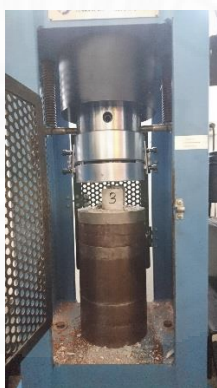
ภาพที่ 3.26 การทดสอบกำลังรับแรงอัดของมอร์ตาร์
