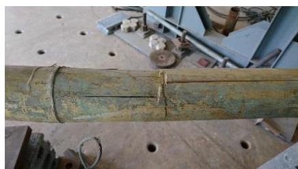
ภาพที่ 4.4 การวิบัติแบบแรงเฉือน (local crushing) และการวิบัติจากแรงอัดบริเวณส่วนบนของหน้าตัดลำไฟ
