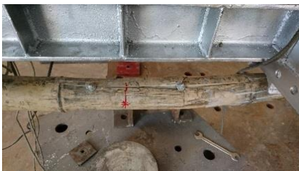
ภาพที่ 4.2 การวิบัติแบบรอยแตกตามความยาว (splitting) บริเวณหัวนอตของเหล็กเกลียวตลอด
