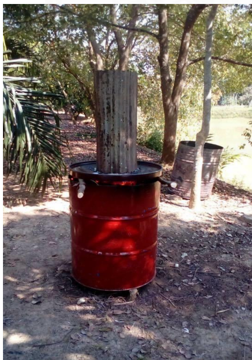
ภาพที่ 4.3 ลักษณะเตาเผาตัดแปลงจากถังเหล็ก ขนาด 200 ลิตร โดย นูร์มะห์ ลูติง, 2560.
