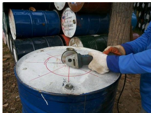
ภาพที่ 4.2 ลักษณะการเจาะบริเวณด้านบนของถัง เพื่อทำเป็นฐานสำหรับทำปล่องควัน โดย นูร์มะห์ ลูติง, 6 มิถุนายน 2560.
