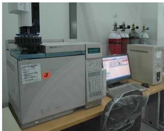
ภาพที่ 3.4 เครื่องแก๊สโครมาโตกราฟฟี
