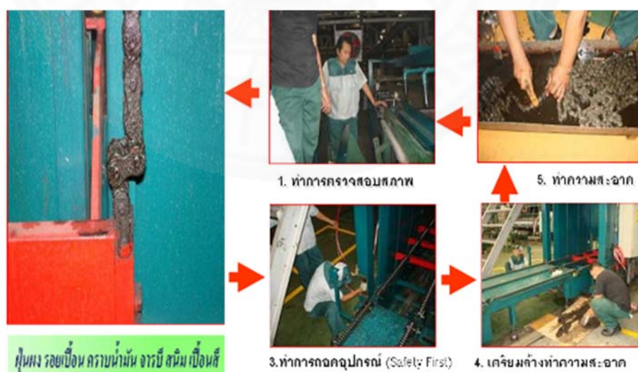
ภาพที่ 4.5 การทำความสะอาดแบบและตรวจสอบความผิดปกติเครื่องจักร
