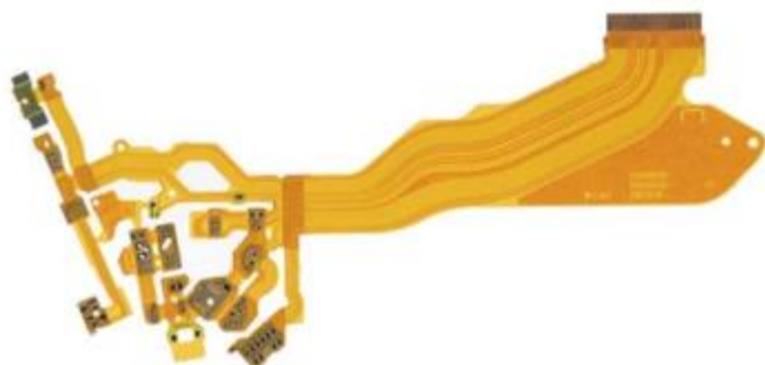
ภาพที่ 3.2 ลักษณะชิ้นส่วนแผงวงจรอิเล็กทรอนิกส์แบบด้านเดียว ที่มา : บริษัททรนิตศึกษา
