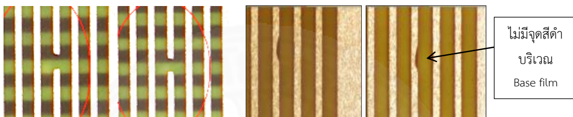
ภาพที่ 3.29 ลักษณะการเกิดข้อบกพร่อง Open/Nick same PT จากกระบวนการ RXD
