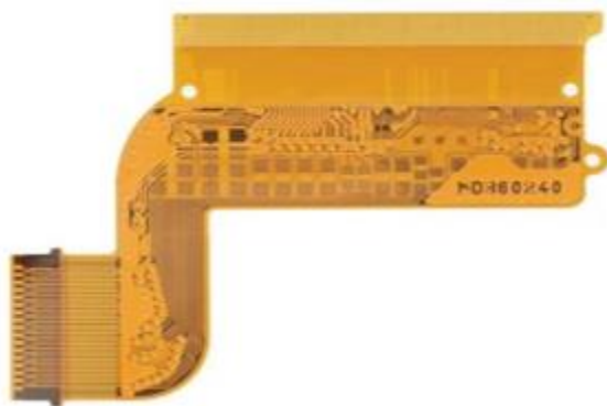
ภาพที่ 3.4 ลักษณะชิ้นส่วนแผงวงจรอิเล็กทรอนิกส์แบบสองด้าน ที่มา : บริษัททรนิตศึกษา
