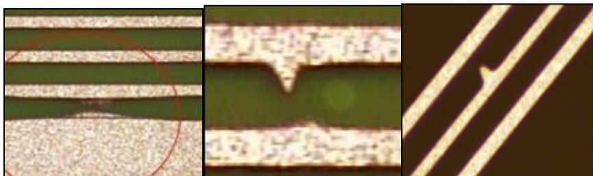
ภาพที่ 3.22 ลักษณะการเกิดข้อบกพร่องประเภท Protrusion ที่มา : บริษัทกรณีสึกษา
