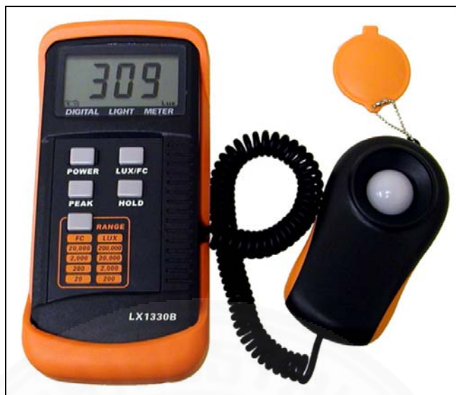
ภาพที่ 3.4 แสดงเครื่องมือที่ใช้วัดแสง
