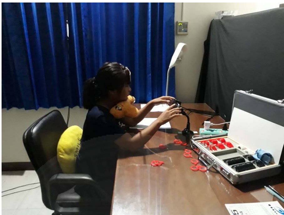
ภาพแสดงการทดลองขณะเล่นเกมส์จับคู่สัตว์ที่ความสว่างของแสง 50 ลักซ์
