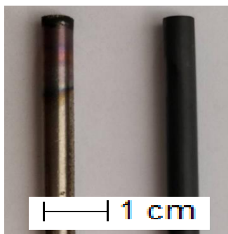
ภาพที่ 4.10 อิเล็กโทรด ไทเทเนียมและกราไฟท์ หลังกัดอาร์คด้วยไฟฟ้า
