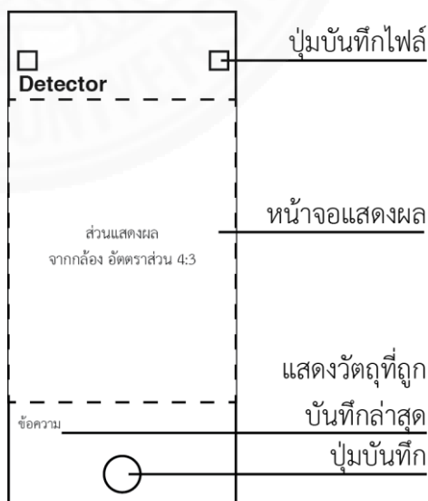
ภาพที่ 4.5 ภาพแสดงภาพส่วนต่อประสานกราฟฟิกกับของแอปพลิเคชันกล้องบน iOS (ซ้าย) แผนผังแสดงส่วนต่อประสานกราฟฟิกของแอปพลิเคชันที่ถูกพัฒนาขึ้น (ขวา). โดย ผู้วิจัย.
