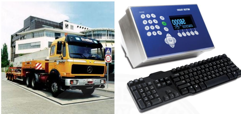
ภาพที่ 5.4 ระบบชั่งน้ำหนัก รถพ่วง 18 ล้อ ขนาด 50 ตัน
