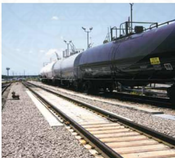
ภาพที่ 5.5 ระบบชั่งน้ำหนัก รถไฟ ขนาด 50 ตัน
