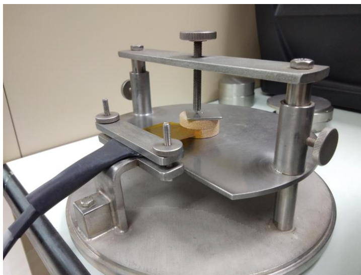
ภาพที่ 3.8 ลักษณะการเตรียมและวางตัวอย่างชิ้นงานทดสอบการนำความร้อน
