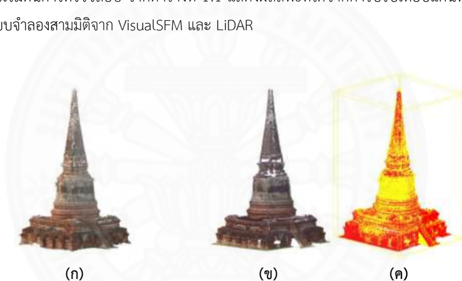
ภาพที่ 2.9 (ก) แบบจำลองสามมิติจากภาพถ่ายผ่าน VisualSFM (ข) แบบจำลองสามมิติจากเทคโนโลยี LiDAR (ค) ผลลัพธ์ที่ได้จากการเปรียบเทียบพิคัดอ้างอิงของแบบจำลองสามมิติระหว่างชุดข้อมูล VisualSFM และ เทคโนโลยี LiDAR (Bhadrakom (2016))
