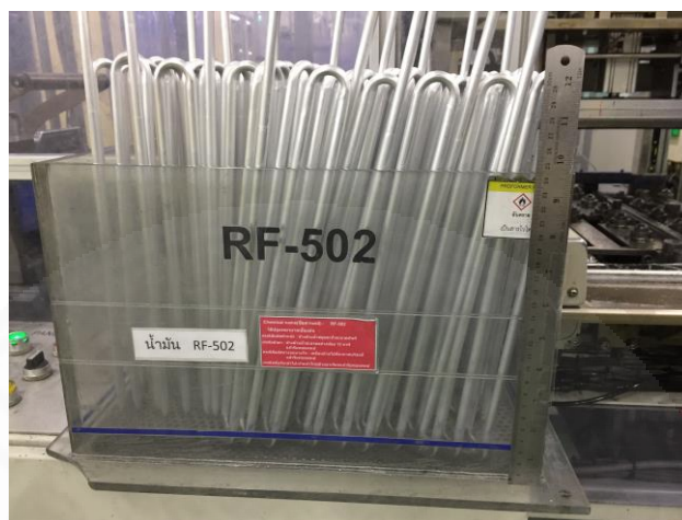
ภาพที่ 3.30 ระดับน้ำมันหล่อลื่น RF-502 ที่ใช้ในการทดลอง
