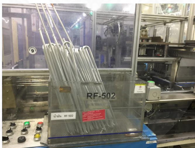
ภาพที่ 3.8 ชิ้นงานท่ออลูมิเนียมจุ่มน้ำมันหล่อลื่น
