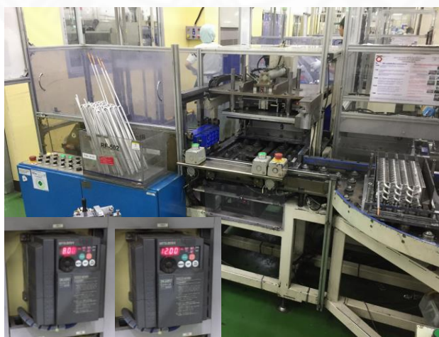
ภาพที่ 3.31 เครื่องประกอบควบคุมความเร็วด้วยอินเวอร์เตอร์
