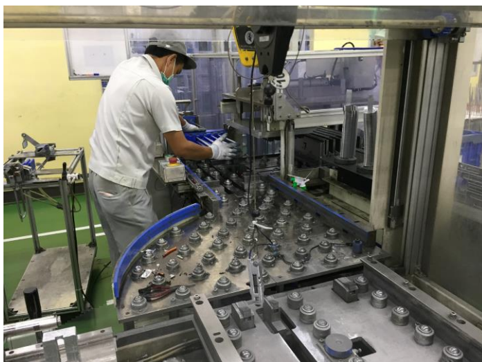
ภาพที่ 3.7 พนักงานนำท่ออลูมิเนียมเตรียมประกอบเข้ากับอลูมิเนียมฟิน
