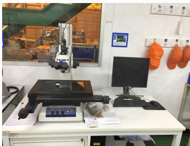
ภาพที่ 3.22 กล้องจุลทรรศน์ใช้วัดขนาดรูอลูมิเนียมเฟือง
