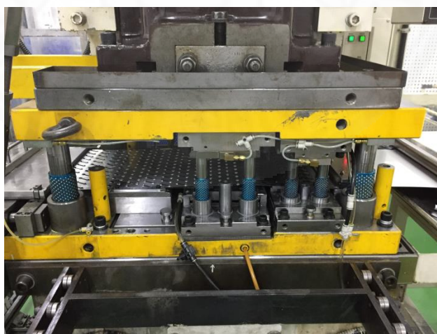
ภาพที่ 3.20 แม่พิมพ์โลหะสำหรับผลิตอลูมิเนียมพิน
