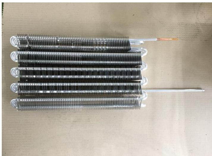
ภาพที่ 3.15 ชิ้นงานคอยล์เครื่องระเหยสำเร็จรูปเตรียมส่งกระบวนการต่อไป
