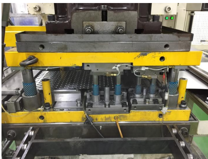
ภาพที่ 3.11 แม่พิมพ์ปั๊มชิ้นรูปอลูมิเนียมพิน
