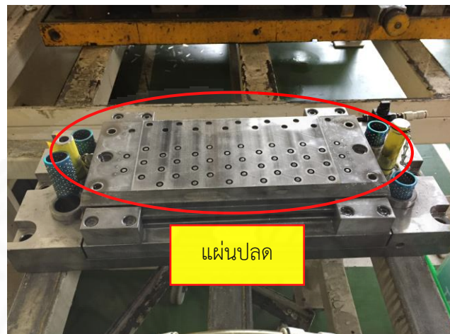
ภาพที่ 3.28 แผ่นปลดและชิ้นส่วนทำหน้าที่ดันขึ้นรูป
