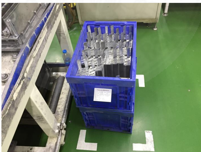
ภาพที่ 3.12 อลูมิเนียมพินจากแม่พิมพ์ปั๊มชิ้นรูปเตรียมใช้งาน
