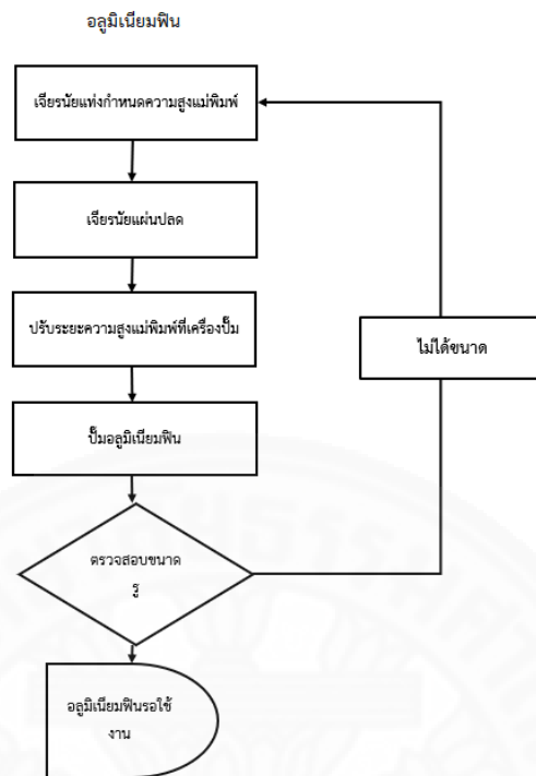
ภาพที่ 3.26 ขั้นตอนการแก้ไขอลูมิเนียมพิน
