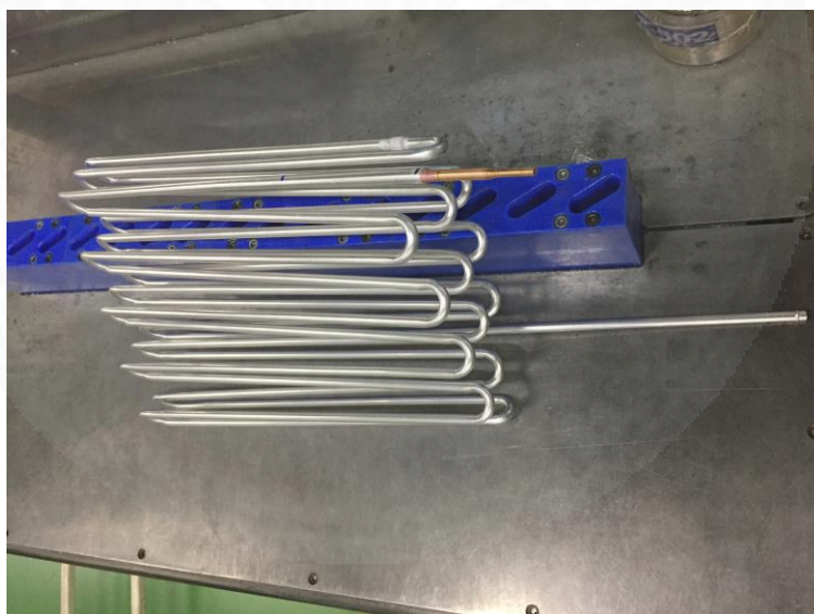
ภาพที่ 3.6 ชิ้นงานท่ออลูมิเนียมที่ผ่านการตัดและเตรียมประกอบ
