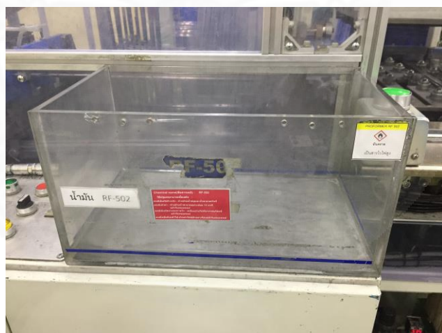
ภาพที่ 3.24 อ่างน้ำมันสำหรับจุ่มท่ออลูมิเนียมก่อนใส่เครื่องประกอบ
