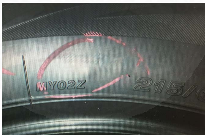
ภาพที่ 1.2 แก้มยางที่มีร่องความลึกไม่ได้ตามค่าเป้าหมายที่ผ่านกระบวนการขึ้นรูปยาง
