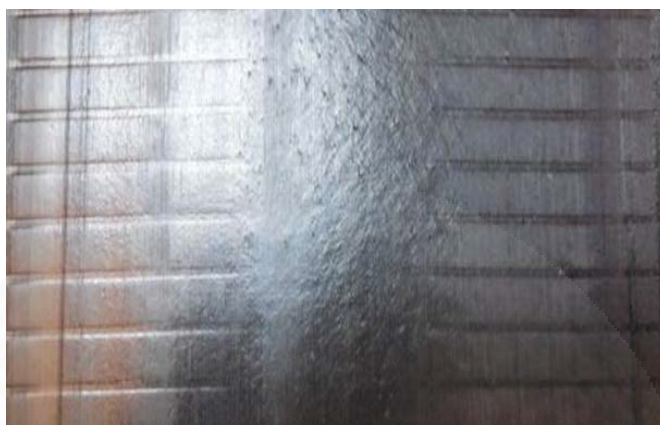
ภาพที่ 1.1 ท้องแก้มยางที่มีร่องความลึกไม่ได้ตามค่าเป้าหมาย
