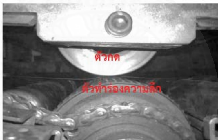
ภาพที่ 3.6 ลักษณะของตัวกดและตัวทำร่องความลึก
