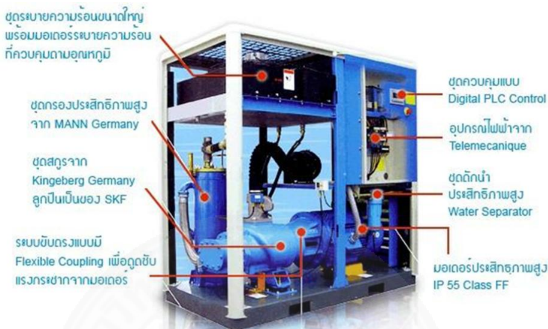
ภาพที่ 2.4 เครื่องอัดอากาศแบบสกรู
