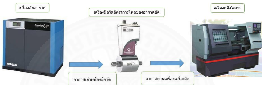
ภาพที่ 3.3 วิธีการตรวจวัดอัตราการไหลของอากาศอัด
