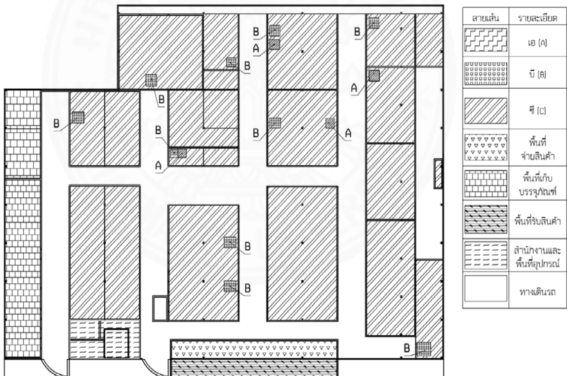
ภาพที่ 3.11 แผนผังคลังสินค้าที่ใช้งานจริง (ก่อนปรับปรุง) ที่มีการระบุตำแหน่งกลุ่มสินค้าที่แบ่งตามความถี่ในการเคลื่อนไหวของสินค้าคงคลัง
