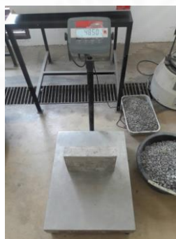
ภาพที่ 3.10 เครื่องชั่งดิจิตอล แบบวางพื้น ชั่งน้ำหนักได้ละเอียดถึง 10 กรัม, ถ่ายโดยผู้วิจัย เมื่อวันที่ 4 เมษายน 2561
