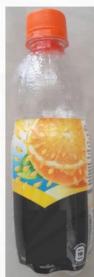
ภาพที่ 2.10 ขวดพลาสติก PET แบบที่ 1 ขนาด 335 มิลลิลิตร กว้าง 5 เซนติเมตร ยาว 18.5 เซนติเมตร, จาก ภาพถ่ายโดยผู้วิจัย เมื่อวันที่ 4 เมษายน 2561
