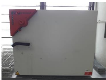
ภาพที่ 3.11 เตอบไฟฟ้าที่สามารถควบคุมอุณหภูมิได้ 105-110°C, ถ่ายโดยผู้วิจัย เมื่อวันที่ 4 เมษายน 2561
