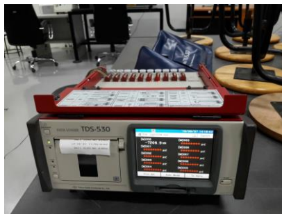
ภาพที่ 3.14 เครื่องเก็บข้อมูล Data logger รุ่น TDS-530, ถ่ายโดยผู้วิจัย เมื่อวันที่ 4 เมษายน 2561
