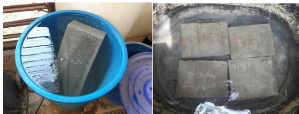
ภาพที่ 3.22 การทดสอบการดูดซึมน้ำของคอนกรีตบล็อกที่มีขวดพลาสติก PET เป็นส่วนประกอบ, ถ่ายโดยผู้วิจัย เมื่อวันที่ 4 เมษายน 2561
