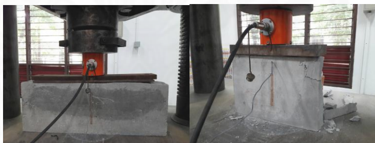
ภาพที่ 3.23 การทดสอบโมดูลัสยืดหยุ่นของคอนกรีตบล็อกที่มีขวดพลาสติก PET เป็นส่วนประกอบ, ถ่ายโดยผู้วิจัย เมื่อวันที่ 4 เมษายน 2561
