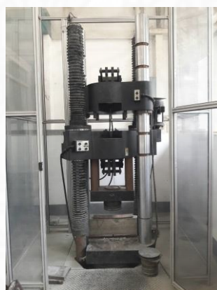
ภาพที่ 3.12 เครื่องทดสอบกำลังรับแรงอัด 690 เมกะพาสคาล, ถ่ายโดยผู้วิจัย เมื่อวันที่ 4 เมษายน 2561
