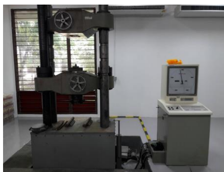
ภาพที่ 3.13 เครื่องทดสอบกำลังรับแรงอัด 200 ตัน, ถ่ายโดยผู้วิจัย เมื่อวันที่ 4 เมษายน 2561
