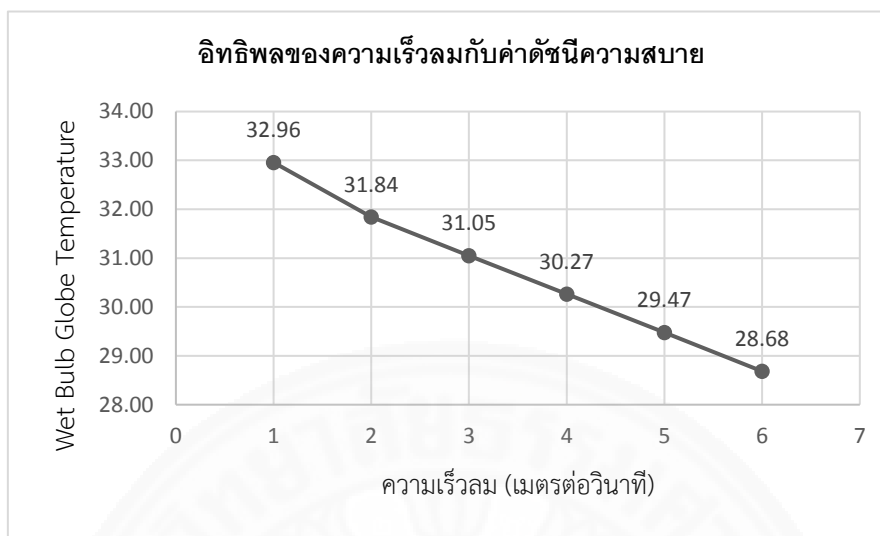
ภาพที่ 2.8 กราฟแสดงอิทธิพลของความเร็วลมกับค่าดัชนีความสบาย (ที่มา: โดยผู้วิจัย)
