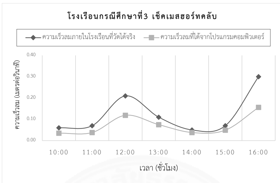
ภาพที่ 3.19 กราฟเปรียบเทียบความเร็วลมภายในโรงเรียนและ ความเร็วลมที่วัดได้จากโปรแกรมคอมพิวเตอร์ เซ็คเมสฮอร์ทคลับ. โดย ผู้ทำวิจัย. 2560
