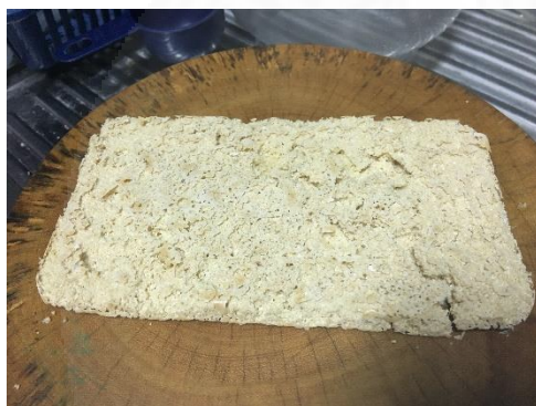
ภาพที่ 3.7 การขึ้นรูปด้วยสารละลายเกลือหลังอบ (ถ่ายโดยผู้วิจัย, 2561)
