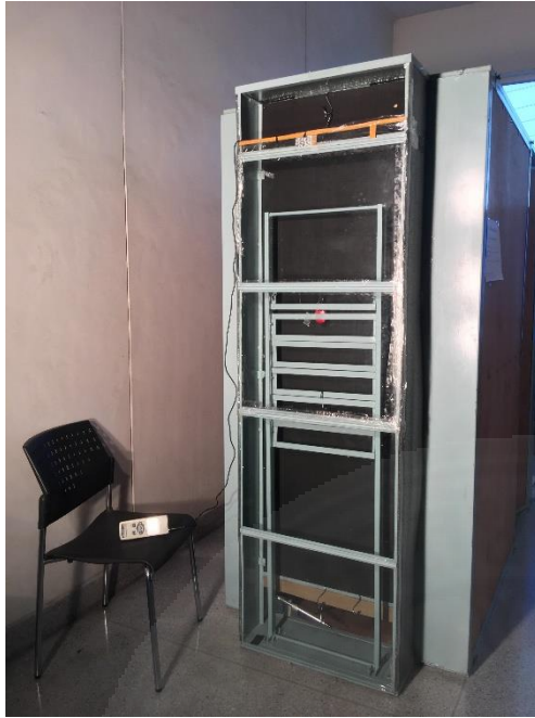
ภาพที่ 5 การทดสอบการทำงานปล่องรังสีอาทิตย์
