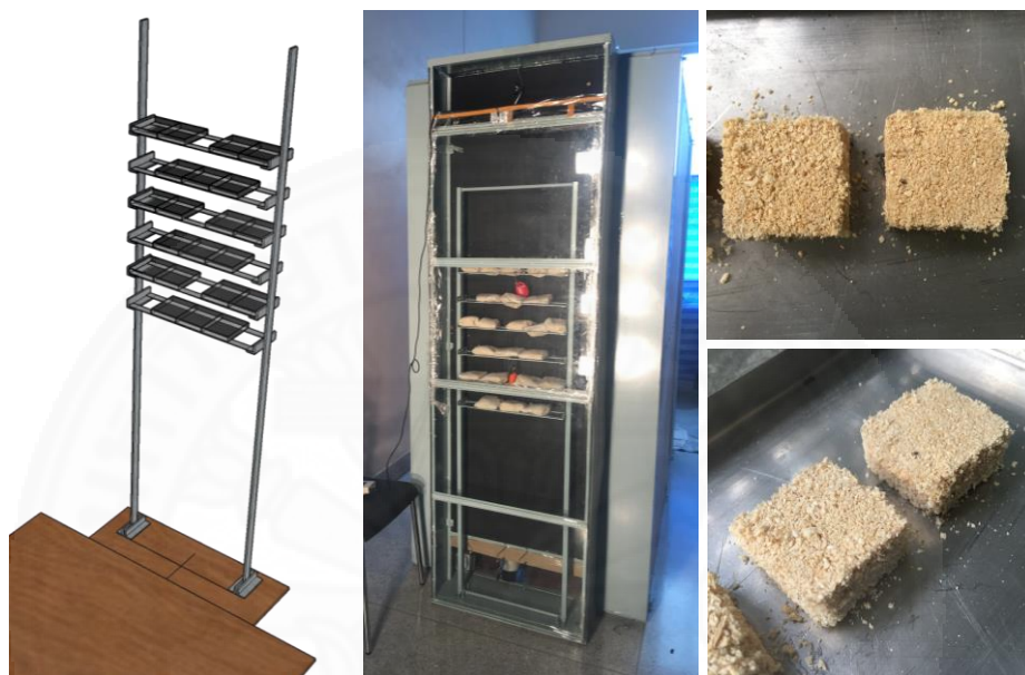
ภาพที่ 3.14 การติดตั้งระแนงวัสดุดูดความชื้น และวัสดุดูดความชื้น (จัดทำโดยผู้วิจัย ,2561)
