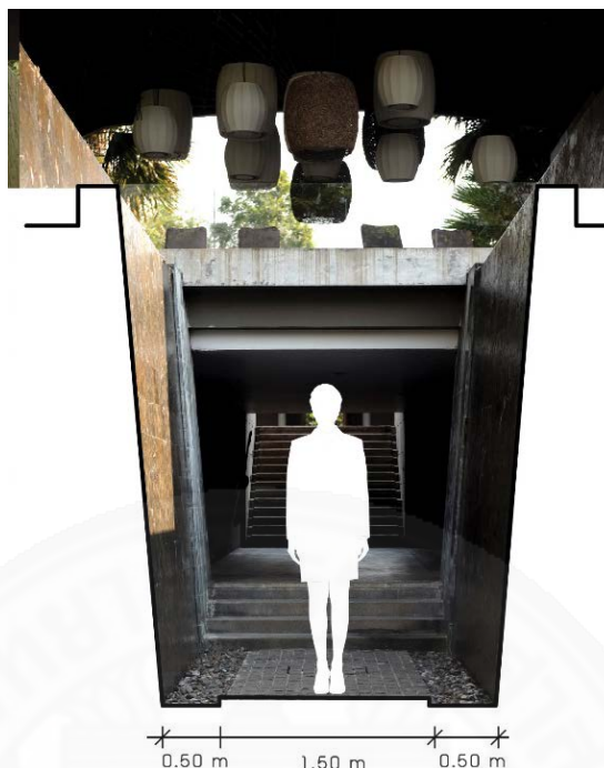
ภาพที่ 4.15 ภาพตัดส่วนทางเดินเชื่อมจากอาคารต้อนรับสู่อาคารที่พักโครงการวิรัตน์ดา เชียงใหม่ เดอะไฮท์ รีสอร์ทท. โดย ผู้วิจัย, 2560.
