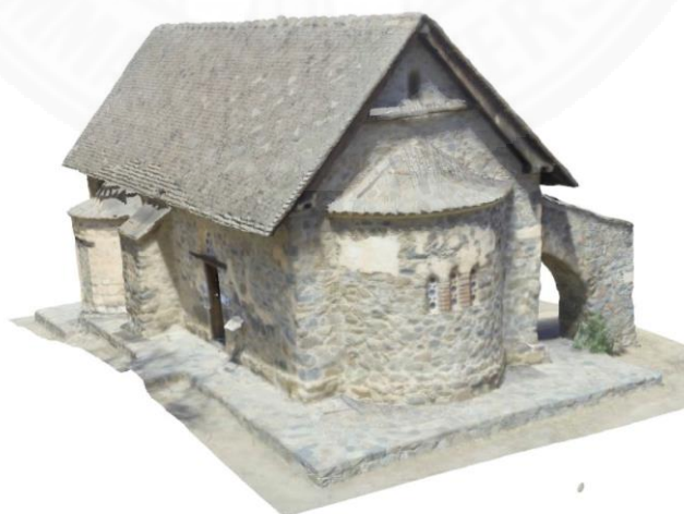
ภาพที่ 2.24 แบบจำลองสามมิติที่เกิดจากโฟโตแกรมเมตรี. จาก The methodology of documenting cultural heritage sites using photogrammetry, UAV and 3D printing techniques , โดย Kyriacos Themistocleous, 2015.
