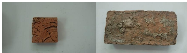
ภาพที่ 3.10 ตัวอย่างอิฐมอญของอุโบสถวัดเชิงเลนที่นำมาใช้ในการทดสอบ. โดย ผู้ทำวิจัย.2560
