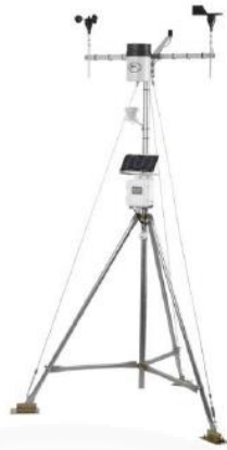
ภาพที่ 3.18 สถานีตรวจวัดสภาพอากาศ HOBO (ที่มา: hobo data loggers. โดย OneTemp)
