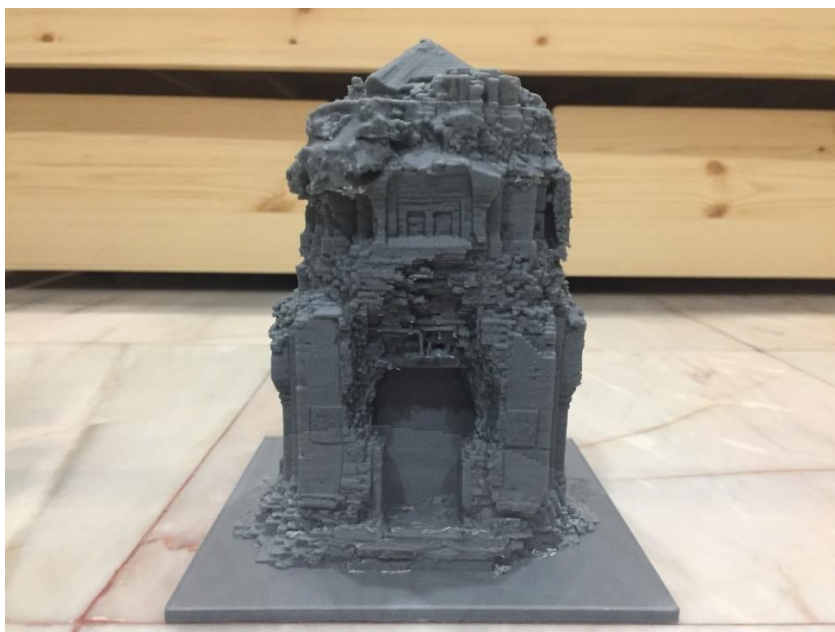
ภาพที่ 4.11 ภาพแบบจำลองกายภาพเมือพิมพ์เสร็จด้วยเครื่องพิมพ์สามมิติ
