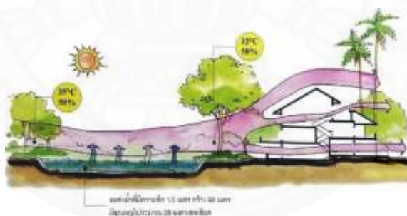
ภาพที่ 3.65 การใช้ประโยชน์จากแหล่งน้ำ ดิน และต้นไม้ในการทำความเย็นให้กับอาคาร (สุนทร บุญญาธิการ, 2542)
