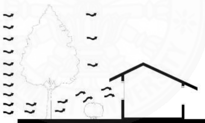
ภาพที่ 3.63 ต้นไม้กำหนดทิศทางลมเข้าสู่อาคาร
