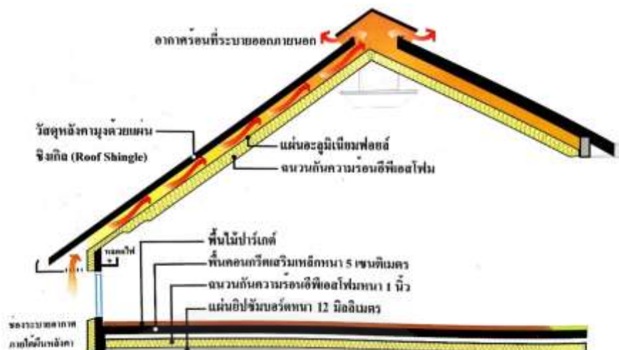
ภาพที่ 2.8 วัสดุและระบบป้องกันความร้อนของหลังคา. จาก เทคนิคการออกแบบบ้านประหยัดพลังงาน เพื่อคุณภาพชีวิตที่ดีกว่า (น.89), โดย สุนทร บุญญาธิการ, 2542
