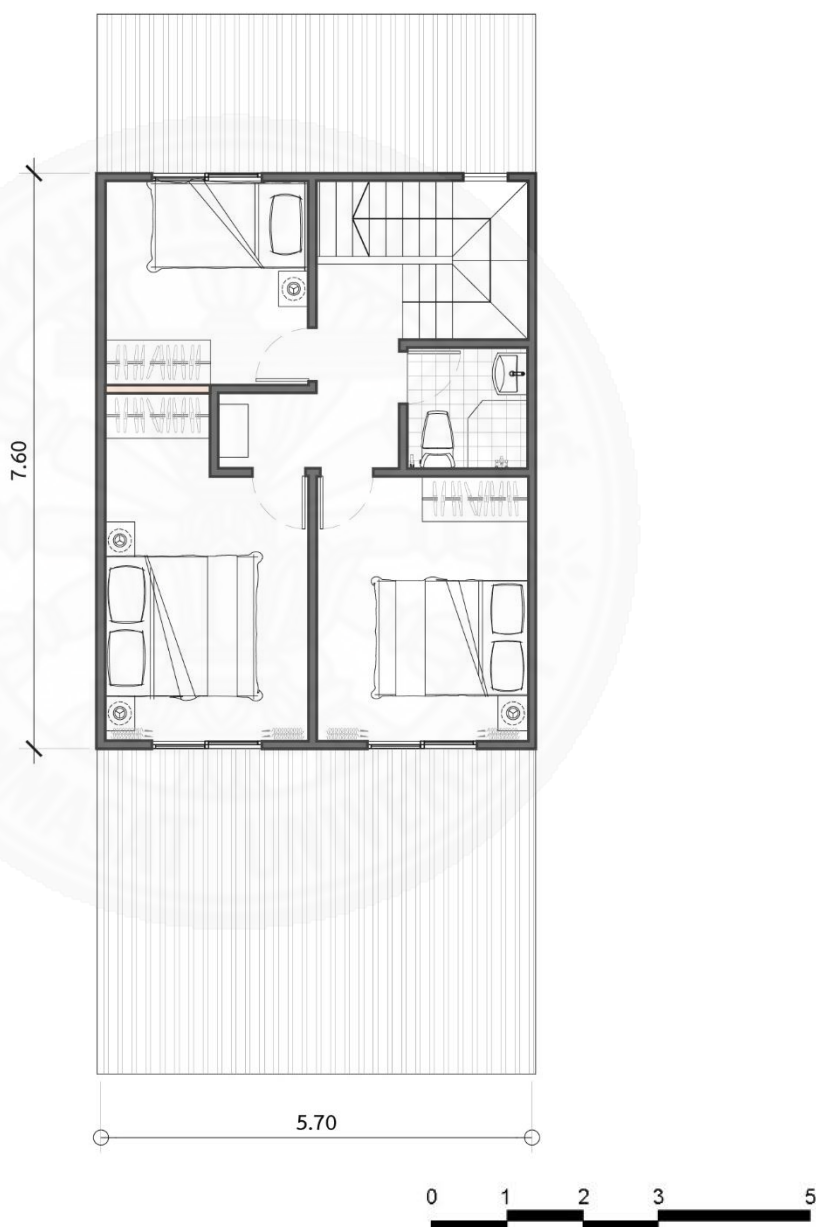
ภาพที่ 5.20 ผังชั้นบนของทาวน์เฮาส์ต้นแบบ สำหรับครอบครัว 3A ในกรณีที่มีการเลี้ยงดูบุตรหลานภายในห้องนอนของตนเอง
