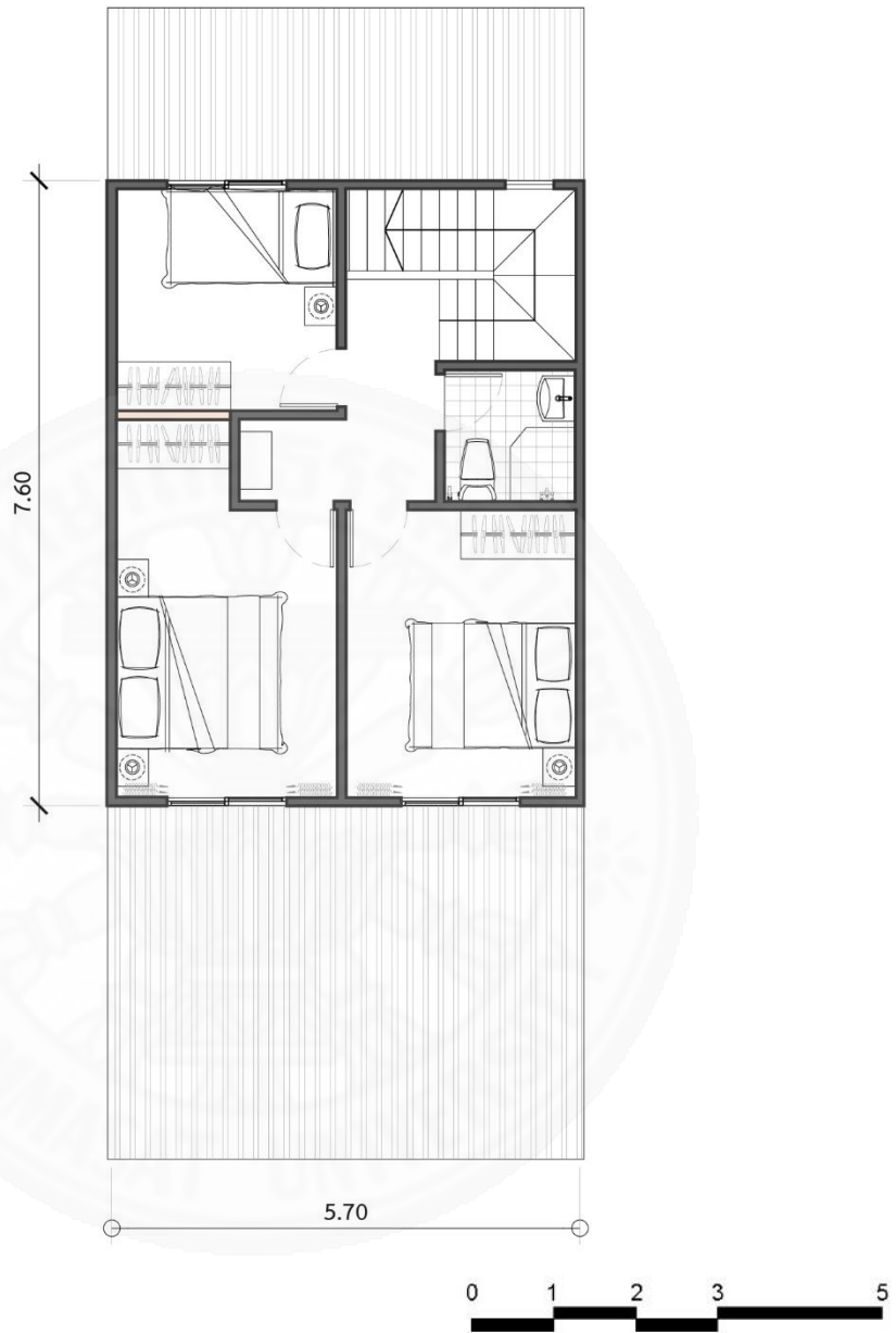
ภาพที่ 5.26 ผังชั้นบนของทาวน์เฮาส์ที่สามารถจัดได้แบบต่าง ๆ
