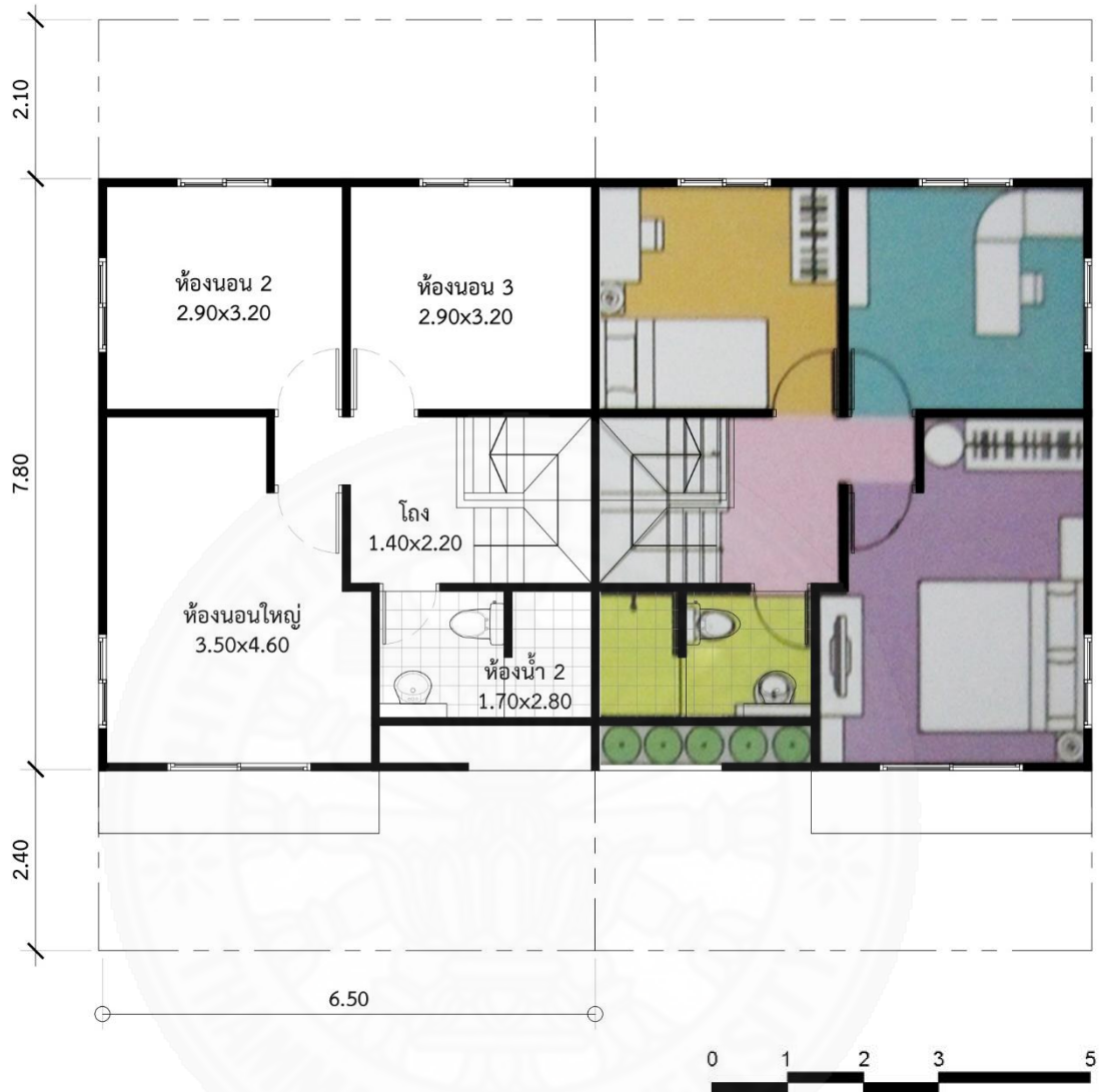
ภาพที่ 4.100 ผังพื้นที่ชั้นบนของรูปแบบทาวน์เฮาส์หน้ากว้าง 6.5 เมตร โครงการเดอะเฟิร์สโฮม รังสิต - ลำลูกกา คลอง 3 จาก The First home วงแหวน ลำลูกกา คลอง 3, โดย t4919, 2554, เข้าถึงได้จาก: https://www.prakard.com/viewtopic.php?t=385543 . ดัดแปลงโดยผู้วิจัย
