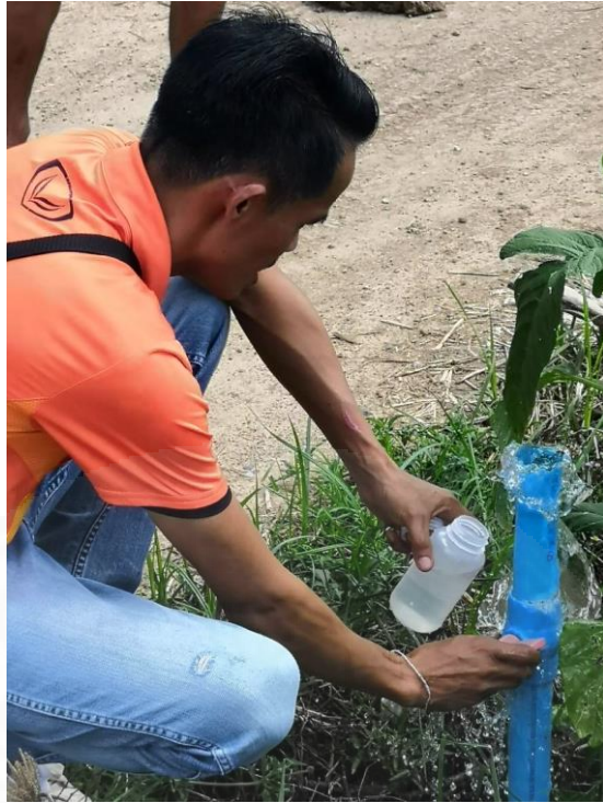
ภาพที่ 3.10 การเก็บตัวอย่างน้ำประปาในท่อจ่ายน้ำ หมู่ที่ 10
