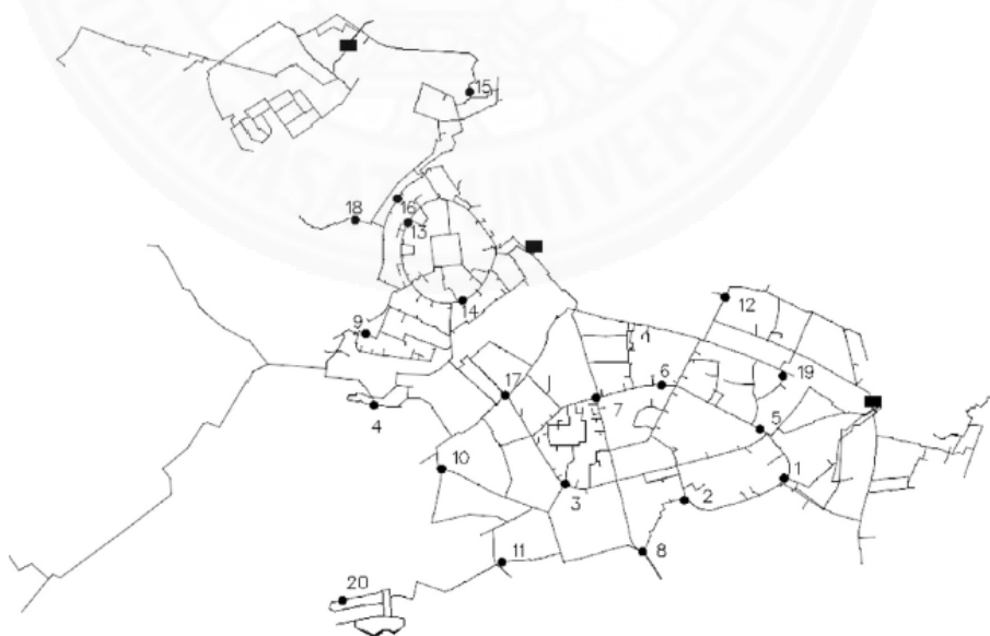
ภาพที่ 2.22 ตำแหน่งการวัดในระบบการจ่ายน้ำ (สีเหลี่ยมสีดำหมายถึงแหล่งจ่ายน้ำ)
