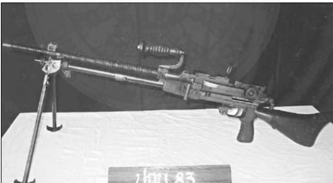
ภาพที่ 4.4 ปืนกลเบา แบบ 83 (ปกบ.83) ระบายความร้อนด้วยอากาศ จากประเทศญี่ปุ่น ที่มา: กรมยุทธการทหารบก, กองประวัติศาสตร์ทหาร, วิวัฒนาการแห่งศัสตราวุธในกองทัพไทย ใน อนุสรณ์งานพระราชทานเพลิงศพพลเอก เสริม ณ นคร ม.ป.ช.,ม.ว.ม.,ท.จ.ว. (กรุงเทพฯ: ครอบครัวพลเอก เสริม ณ นคร, 2553), 186.
