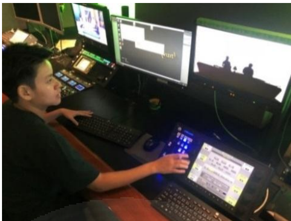
ภาพที่ 5.43 เจ้าหน้าที่คอนเทนต์ไหลอทใช้อุปกรณ์ Ultimatte Smart Remote ในการซ้อนภาพ ฉากเขียว และฉากกราฟิก
