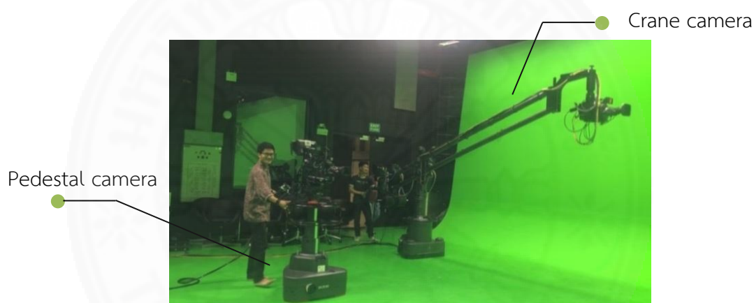
ภาพที่ 4.21 แสดง Crane camera และ Pedestal camera ในฉากเสมือนจริงของสถานีโทรทัศน์ไทยรัฐทีวี
