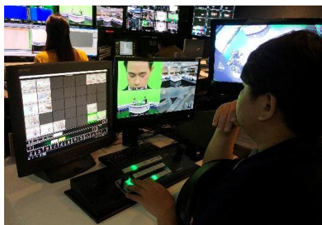
ภาพที่ 5.30 แสดงการกำหนดค่ามุมภาพของ Robotic camera
