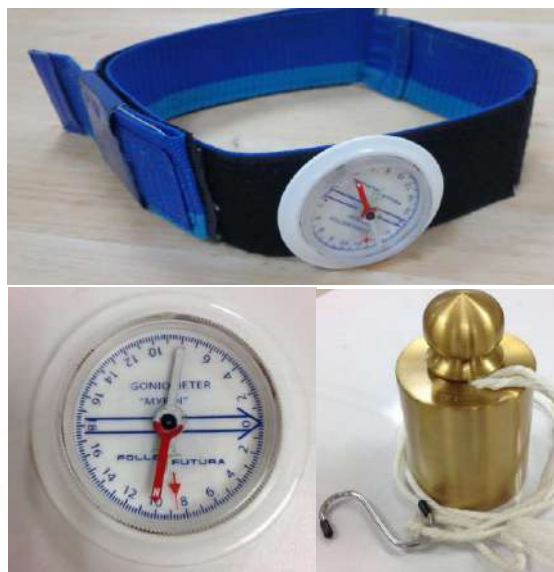
ภาพที่ 3.5 ชุดสำหรับทดสอบความทนทานของกล้ามเนื้อ ประกอบด้วยเข็มขัดที่ยึดกับ inclinometer และ load 2 kg.
