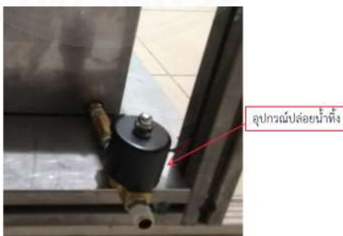
ภาพที่ 3.8 ชุดควบคุมการปล่อยน้ำทิ้งของเครื่องฆ่าเชื้อโรคในเมล็ดพันธุ์อินทรีย์แบบกึ่งอัตโนมัติ
