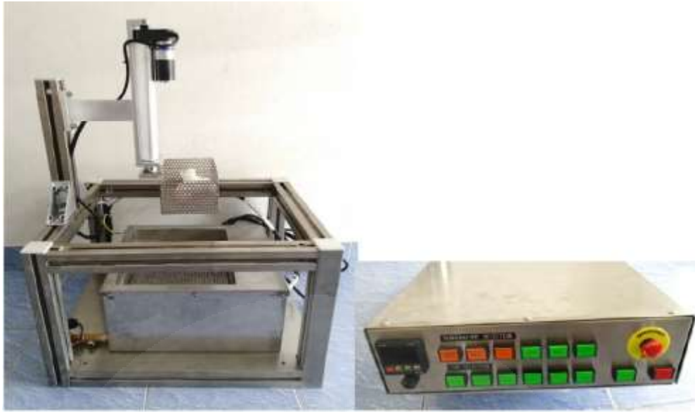
ภาพที่ 4.1 เครื่องฆ่าเชื้อโรคในเมล็ดพันธุ์อินทรีย์แบบกึ่งอัตโนมัติ
