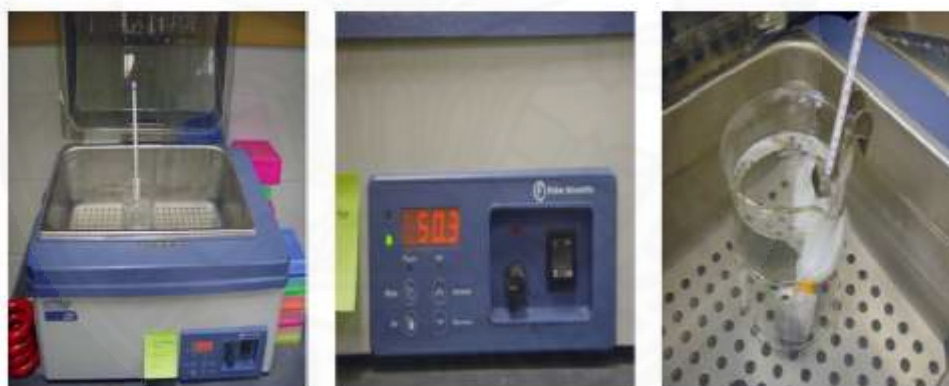
ภาพที่ 2.15 การรักษาระดับอุณหภูมิของน้ำร้อนขณะแช่เมล็ดให้คงที่
