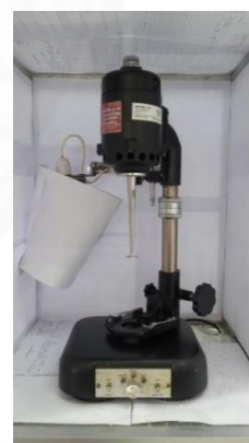
ภาพที่ 3.4 เครื่องวัดความเสถียร เชิงกลของน้ำยางข้น
