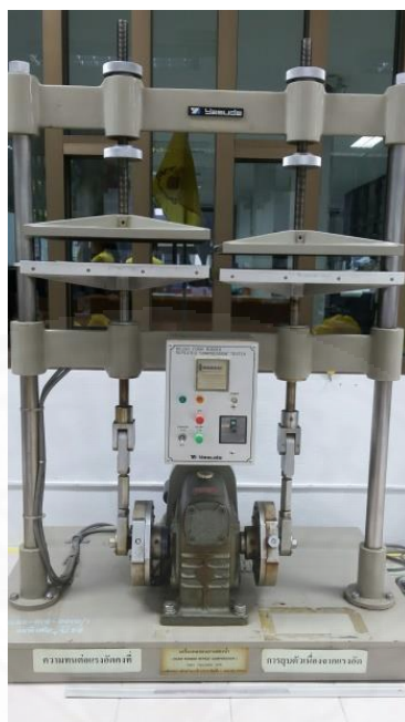
ภาพที่ 3.7 เครื่องทดสอบการยุบตัวเนื่องจากแรงกด
