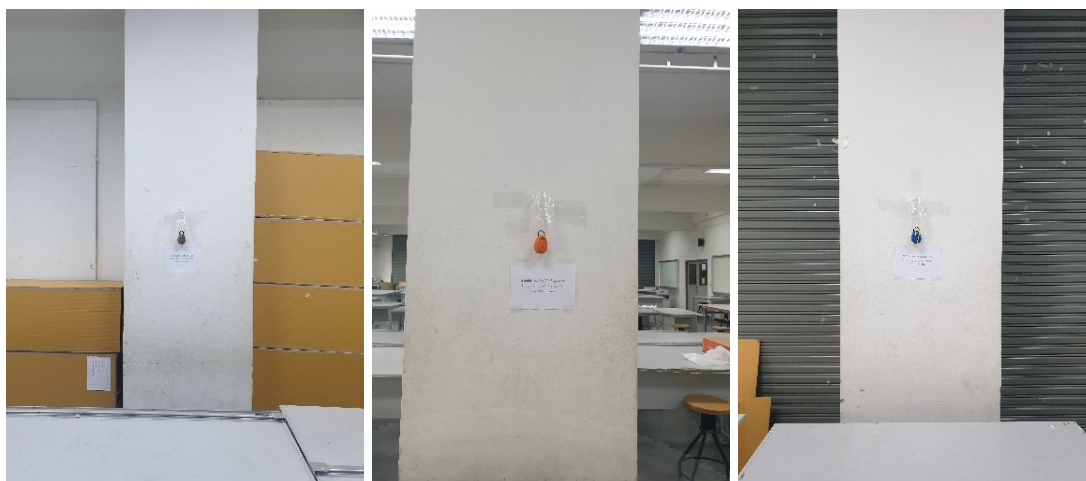
ภาพที่ 3.22 การติดตั้งอุปกรณ์วัดอุณหภูมิและความชื้น
