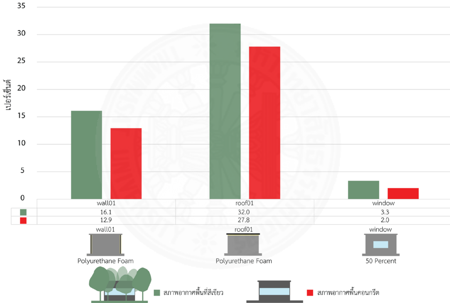
ภาพที่ 6.14 ร้อยละการประหยัดพลังงานของห้องเรียนที่ได้รับอิทธิพลของสภาอากาศพื้นที่สีเขียวและพื้นคอนกรีต
