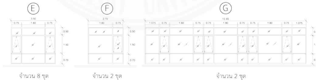
ภาพที่ 3.54 แบบจำลองในโปรแกรม SketchUp และขนาดช่องเปิดเพิ่มขึ้น 3 เท่า
