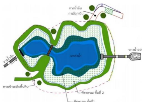
ภาพที่ 2.6 การกักเก็บน้ำด้วยพื้นที่ชุ่มน้ำ (Stormwater wetland), โดย State of New Jersey Department of Environmental, 2004.
