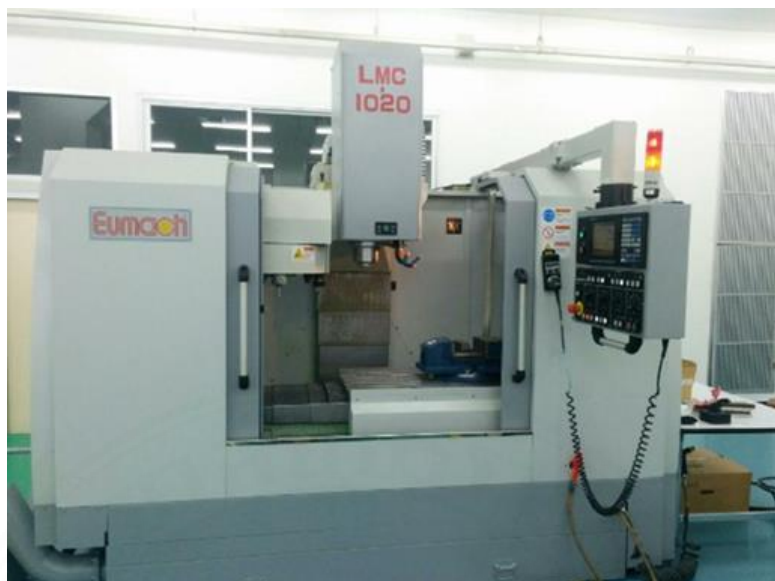
ภาพที่ 3.2 เครื่องกัดซีเอ็นซี EUMACH รุ่น LMC1020
