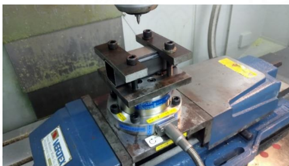
ภาพที่ 3.15 การจับชิ้นงานที่ Dynamometer เพื่อเตรียมการทดลอง
