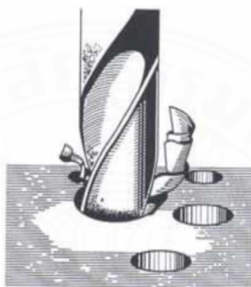
ภาพที่ 2.5 ความเร็วตัดงานเจาะ
