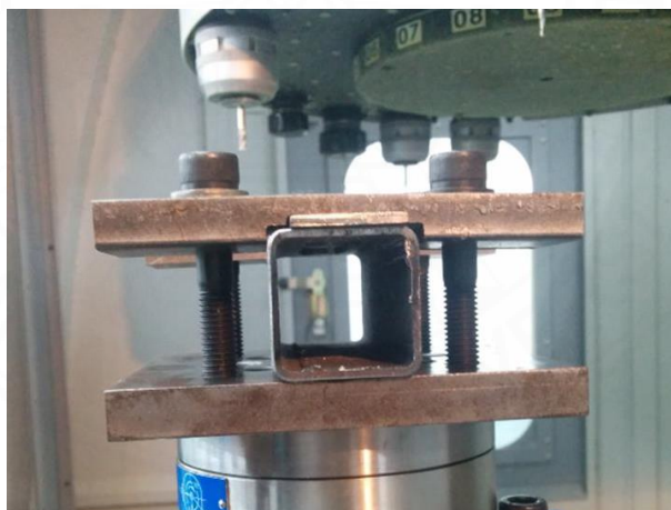
ภาพที่ 3.11 มุมมองด้านข้างการใช้อุปกรณ์ช่วยในการจับยึดจับชิ้นงาน
