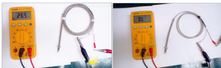
ภาพที่ 2.18 วิธีตรวจเช็คเทอร์โมคัปเปิล
