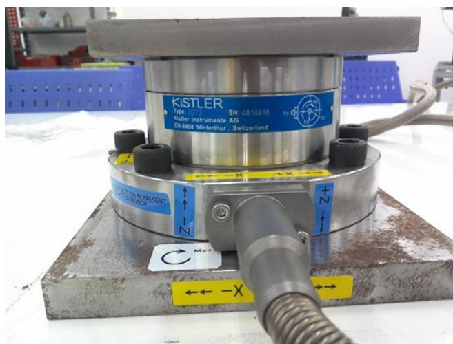
ภาพที่ 2.9 เครื่องวัดแรง แบบ 4 ช่องทาง ยี่ห้อ kistler รุ่น 9272
