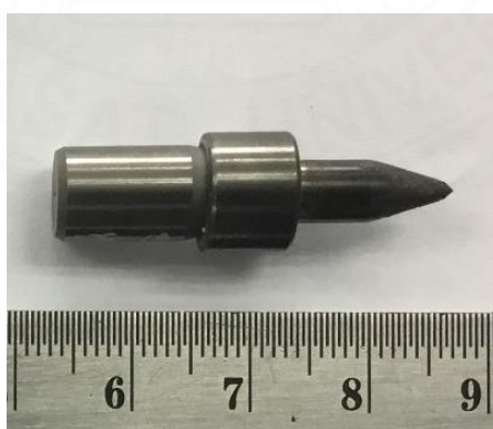
ภาพที่ 3.3 อุปกรณ์เจาะโดยใช้แรงเสียดทานแบบมีป่า
