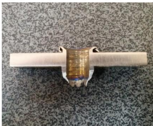
ภาพที่ 4.18 ลักษณะของรูเจาะจากกระบวนการเจาะโดยใช้แรงเสียดทาน
