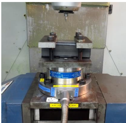
ภาพที่ 3.5 เครื่องวัดแรงตัดเฉือน KISTLER (Dynamometer) ยี่ห้อ KISTLER
