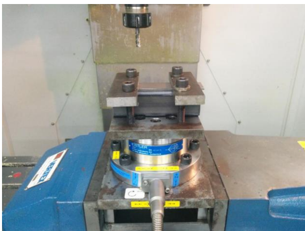
ภาพที่ 3.10 การจับชิ้นงานที่ Dynamometer
