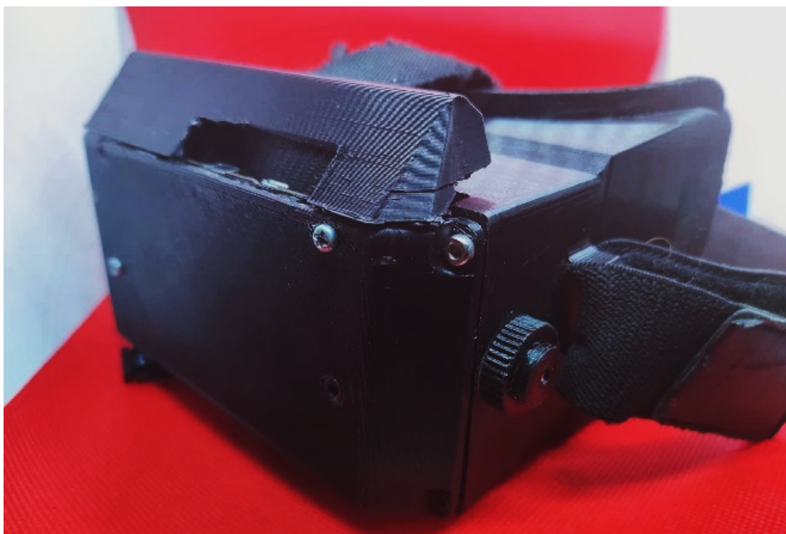
ภาพที่ 2.12 ตัวอย่างแว่นตาจำลองโลกเสมือน GlauCUTU ซึ่งเป็นแบบ PC-VR โดยมี 2 พอร์ตการเชื่อมต่อคือ 1) สายสัญญาณภาพ 2) สายพลังงาน
