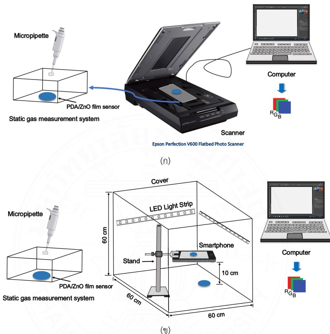
ภาพที่ 4.2 การจัดการทดลองสำหรับการวิเคราะห์ทางสีจากรูปภาพ (ก) ด้วยเครื่องสแกนเนอร์ และ (ข) ด้วยกล้องถ่ายภาพบนโทรศัพท์เคลื่อนที่ เพื่อศึกษาการตอบสนองการเปลี่ยนสีของฟิล์ม ต่อแก๊สแอมโมเนียและแก๊สทดสอบชนิดต่าง ๆ
