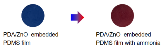
ภาพที่ 4.4 สีของฟิล์มพอลิไดแอเซทิลีน/ซิงค์ออกไซด์/พอลิไดเมทิลไซโลเซน ก่อนและหลังทดสอบกับแก๊สแอมโมเนีย 1000 พีพีเอ็ม
