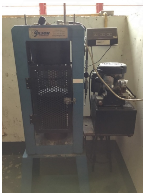
ภาพที่ 3.31 เครื่องทดสอบความแข็งแรงในการรับแรงอัด (Compressive Strength) ยี่ห้อ Gilson
