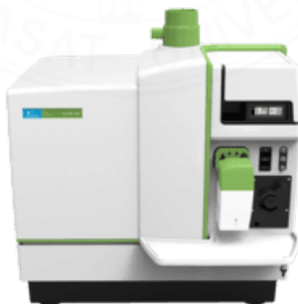
ภาพที่ 3.26 เครื่องวิเคราะห์ปริมาณโลหะหนักด้วยเทคนิค Inductively Coupled Mass Emission Spectroscopy (ICP – MS) ยี่ห้อ PerkinElmer รุ่น NexION 350X 144
