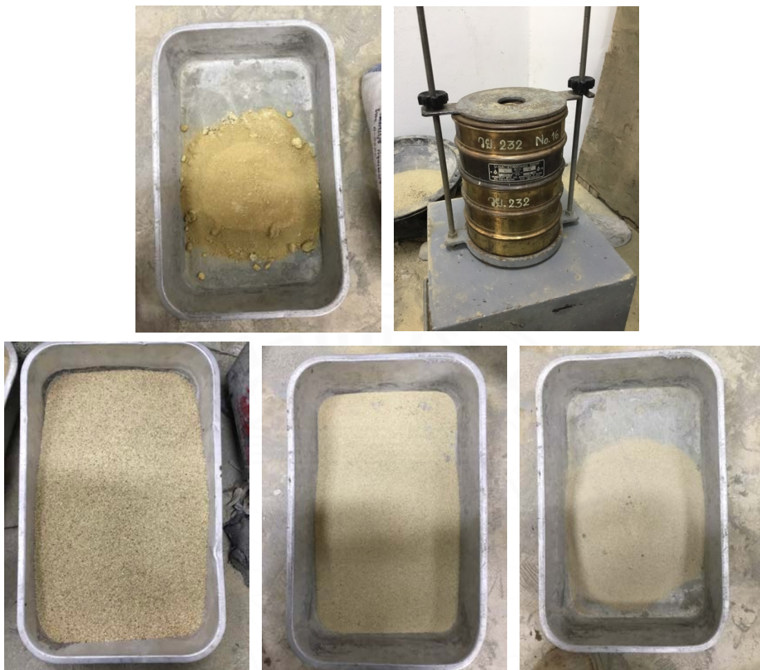
ภาพที่ ๕ - 5 การทดสอบขนาดคละของมวลรวมละเอียด
