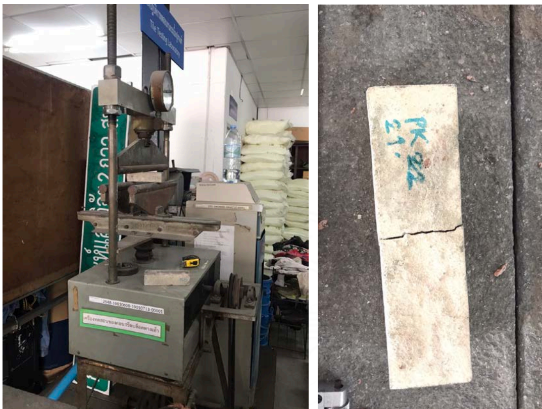
ภาพที่ ซ - 11 การทดสอบกำลังรับแรงดัดของตัวอย่างmortarปรับระดับ
