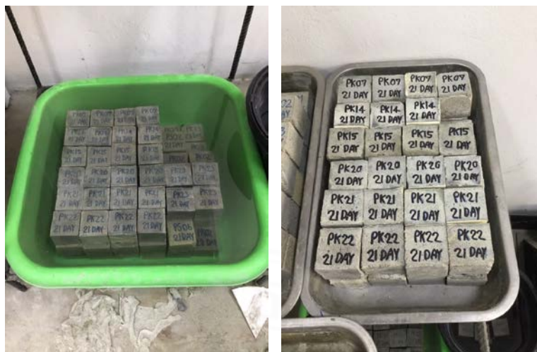
ภาพที่ 3.37 ตัวอย่างมอร์ตาร์ปรับระดับที่บ่มในน้ำและบ่มในอากาศ
