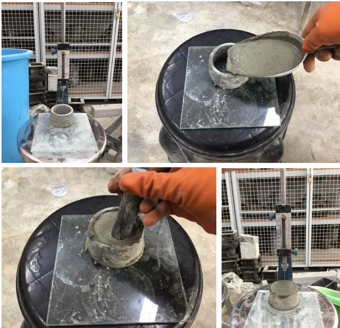
ภาพที่ ๗ - 7 การทดสอบระยะเวลาการก่อตัวของมอร์ตาร์ปรับระดับ (Setting Time)
