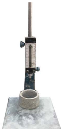
ภาพที่ 3.30 เครื่องทดสอบระยะเวลาการก่อตัว (Vicat Apparatus)
