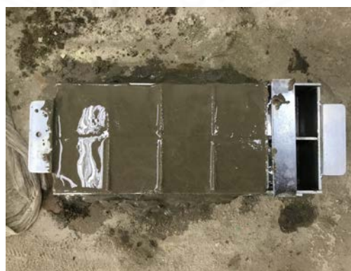
ภาพที่ 3.36 ตัวอย่างมอร์ตาร์ปรับระดับที่เทลงในแบบหล่อ
