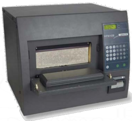
ภาพที่ 3.21 เครื่องวัดการไหลของความร้อน ยี่ห้อ NETZSCH รุ่น HFM 436 Lambda 138
