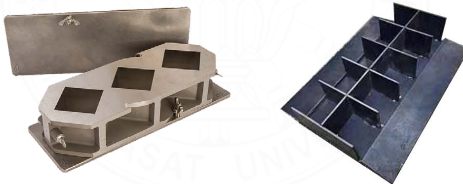
(ก) แบบหล่อตัวอย่างมอร์ตาร์ ชนิดทองเหลือง (ข) แบบหล่อตัวอย่างมอร์ตาร์ ชนิดเหล็กกล้า
