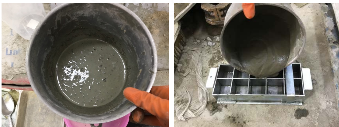
ภาพที่ ๘ - 8 การหล่อตัวอย่างมอร์ตาร์ปรับระดับ
