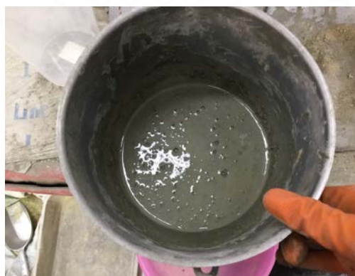
ภาพที่ 3.35 ตัวอย่างมอร์ตาร์ปรับระดับที่ได้จากการผสม
