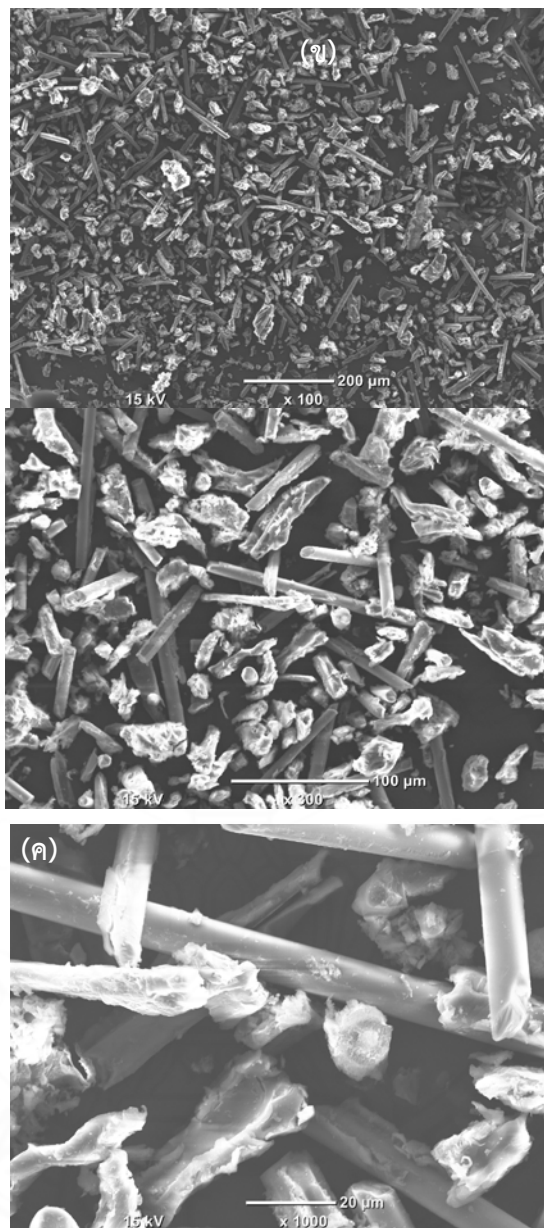
ภาพที่ 4.5 ซากแผงวงจรอิเล็กทรอนิกส์ชนิดเส้นใย ที่ส่องด้วยกล้องจุลทรรศน์อิเล็กตรอนแบบส่องกราด (ก) กำลังขยาย 100X (ข) กำลังขยาย 300X (ค) กำลังขยาย 1,000X
