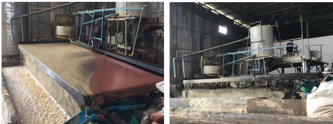
ภาพที่ ซ - 3 กระบวนการคัดแยกซากแผงวงจรอิเล็กทรอนิกส์ส่วนโลหะออกจากส่วนอโลหะ
