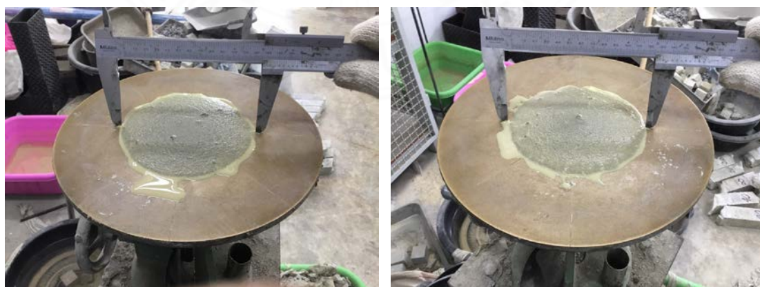
ภาพที่ ๖ - 6 การทดสอบอัตราการไหลของmortarปรับระดับ (Initial Flow)
