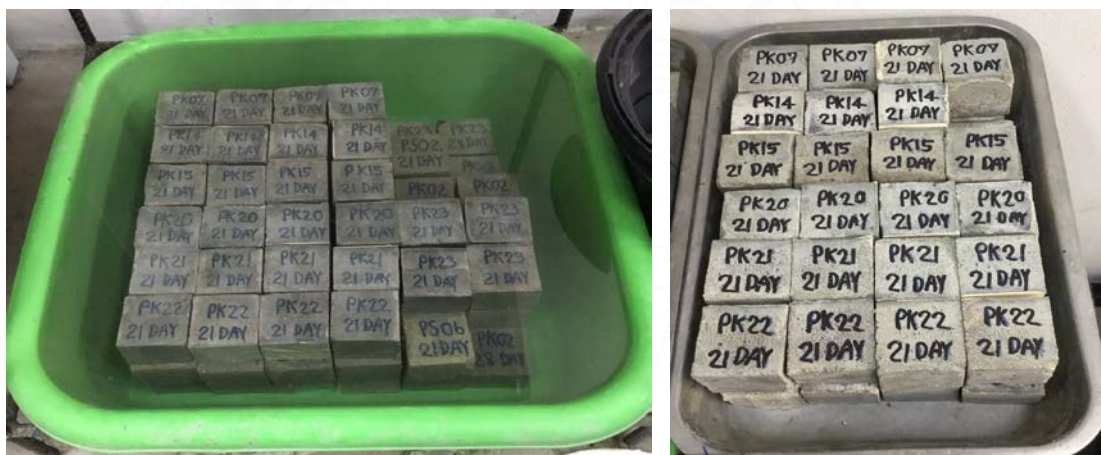
ภาพที่ ๙ - 9 ตัวอย่างมอร์ตาร์ปรับระดับที่บ่มในน้ำและบ่มในอากาศ
