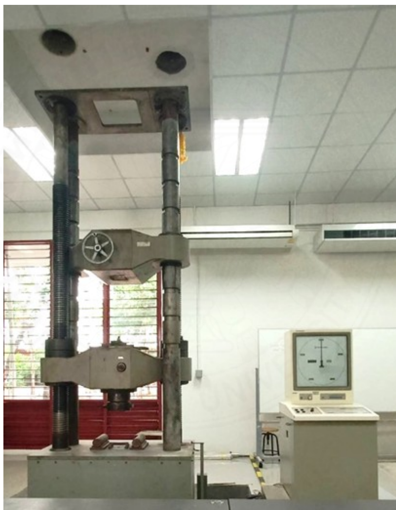
ภาพที่ 3.32 เครื่องทดสอบสมบัติทางกลของวัสดุแบบอเนกประสงค์ (Universal Testing Machine) ยี่ห้อ Shimadzu
