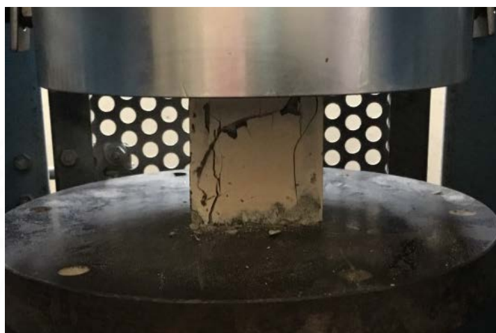
ภาพที่ 4.37 การวิบัติแบบ Non-Explosive Failure
