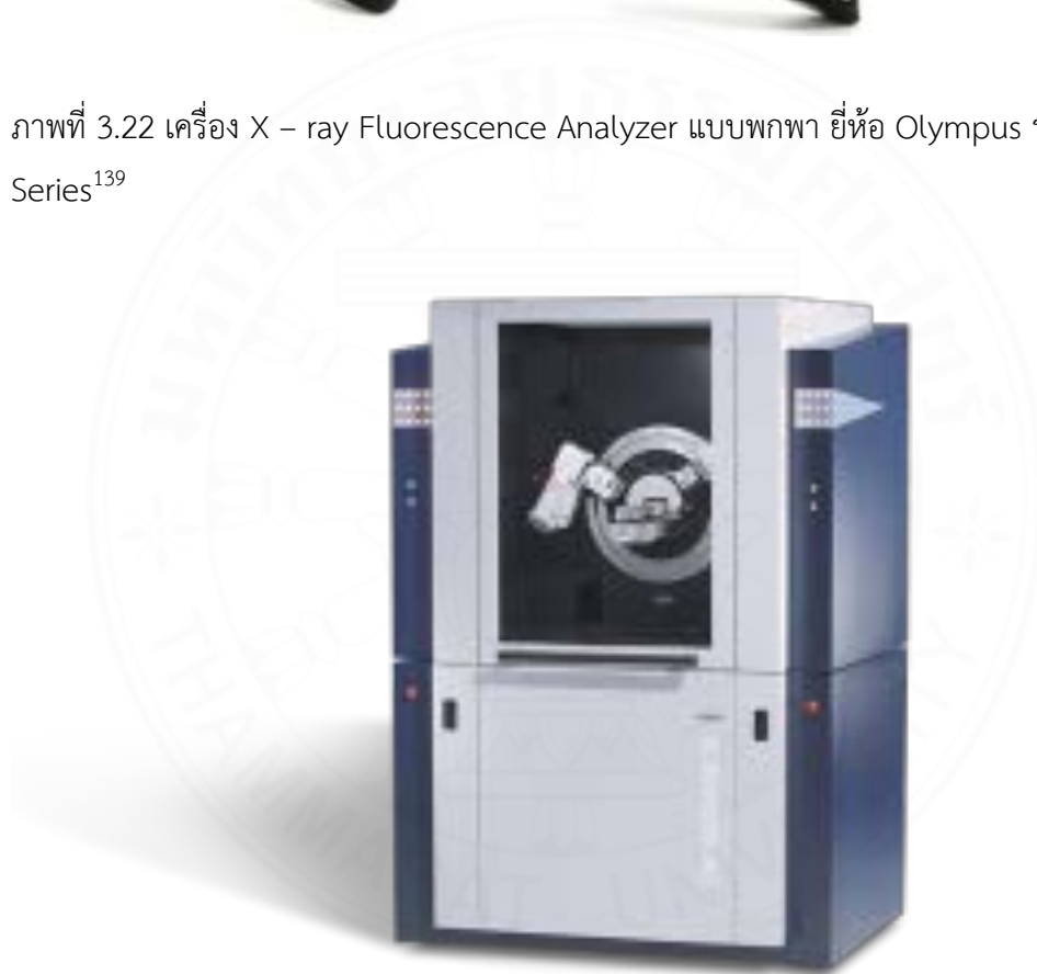
ภาพที่ 3.23 เครื่อง X-ray Diffraction Spectrometer (XRD) ยี่ห้อ Bruker AXS รุ่น D8 Advance 140
