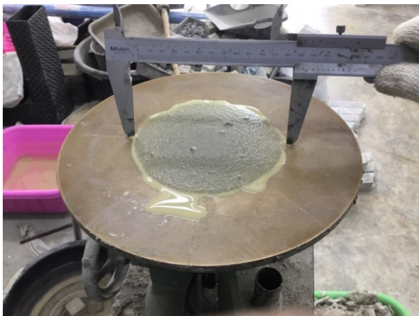
ภาพที่ 3.33 การวัดขนาดเส้นผ่าศูนย์กลางของมอร์ตาร์ปรับระดับ
