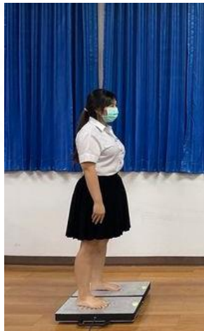
รูปที่ 27 แสดงการยืนบนแผ่นสะท้อนแรงปฏิกิริยาที่พัฒนาขึ้น
