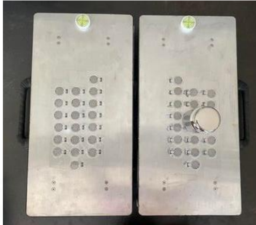
รูปที่ 17 แสดงการทดสอบการวัดผลค่าแรงปฏิกิริยา (reaction force: GRF) ทิศทางแนวตั้ง (vertical)
