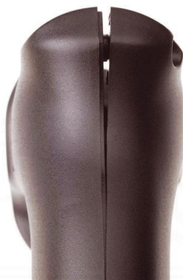
ภาพที่ 2.15 ตัวอย่างการบิดเบี้ยว (Warp) ของชิ้นงาน
