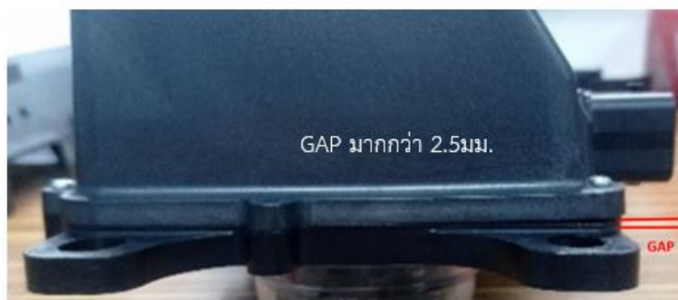
ภาพที่ 3.9 การปิดไม่สนิทและเกิดช่องว่าง (GAP) จากชิ้นงานบิดเบี้ยว
