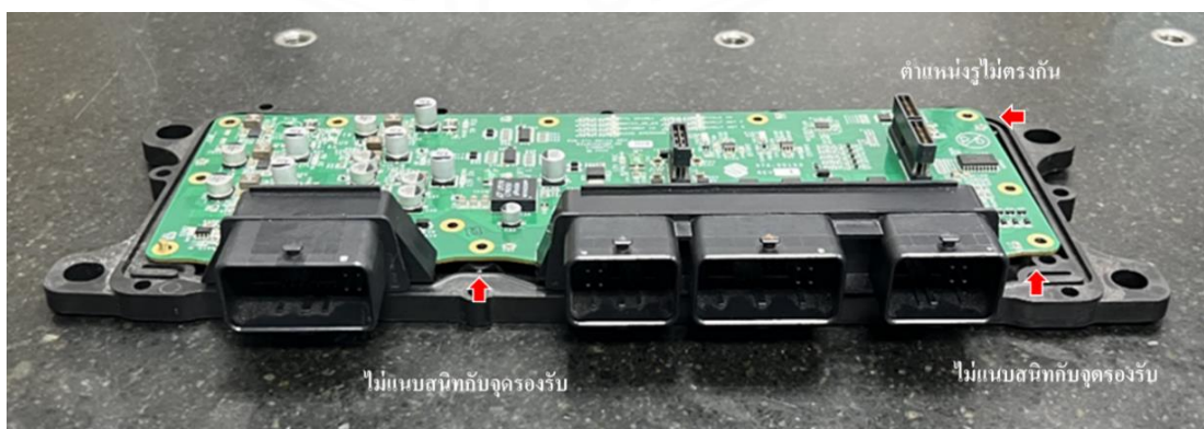
ภาพที่ 1.5 ตัวอย่างงานบิดเบี้ยวและแผ่นวงจรอิเล็กทรอนิกส์
