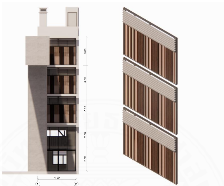
ภาพที่ 5.126 เปลือกอาคารรูปแบบที่ 2 ระแนงไม้สังเคราะห์ Wood Plastic Composite อาคารหลังที่ 6. โดยผู้วิจัย, 2567.
