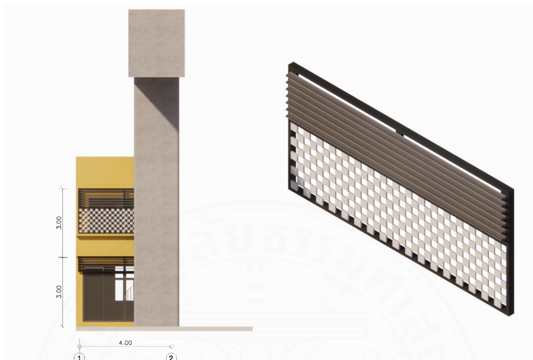
ภาพที่ 5.44 เปลือกอาคารรูปแบบที่ 6 พลาสวูดฉลุลาย. อาคารหลังที่ 2. โดยผู้วิจัย, 2567.
