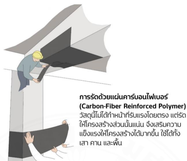
ภาพที่ 2.20 การรัดด้วยแผ่นคาร์บอนไฟเบอร์. จาก เอกรินทร์ พันธุ์นิล, 2567.
