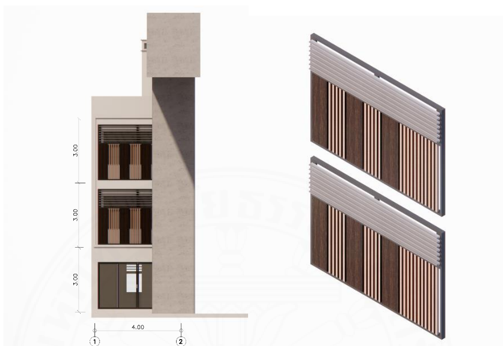
ภาพที่ 5.83 เปลือกอาคารรูปแบบที่ 2 ระแนงไม้สังเคราะห์ Wood Plastic Composite อาคารหลังที่ 4. โดยผู้วิจัย, 2567.
