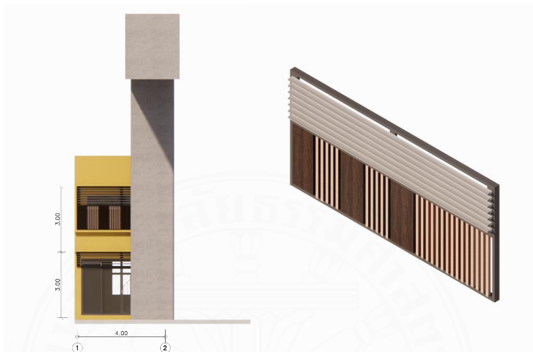
ภาพที่ 5.40 เปลือกอาคารรูปแบบที่ 2 ระแนงไม้สังเคราะห์ Wood Plastic Composite อาคารหลังที่ 2. โดยผู้วิจัย, 2567.
