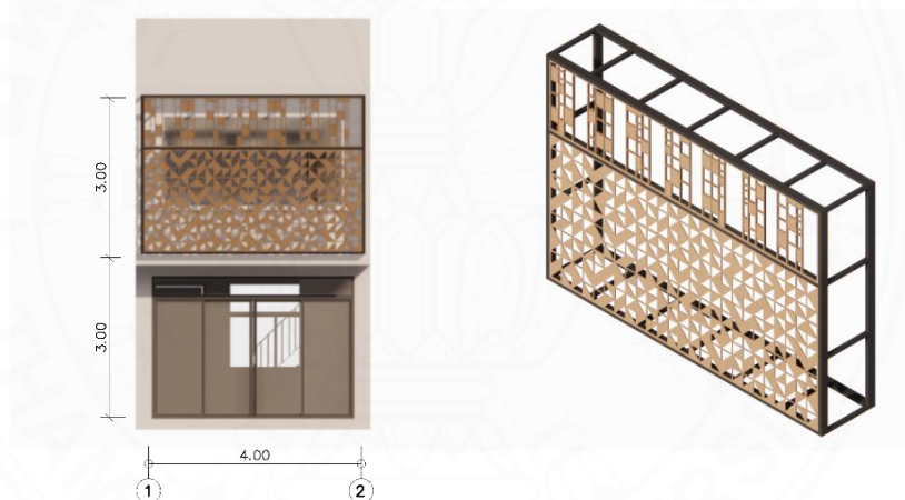
ภาพที่ 5.23 เปลือกอาคารรูปแบบที่ 3 อลูมิเนียมคอมโพสิตฉลุลาย. อาคารหลังที่ 1. โดยผู้วิจัย, 2567.
