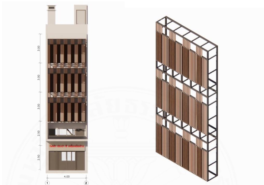
ภาพที่ 5.104 เปลือกอาคารรูปแบบที่ 2 ระแนงไม้สังเคราะห์ Wood Plastic Composite อาคารหลังที่ 5. โดยผู้วิจัย, 2567.
