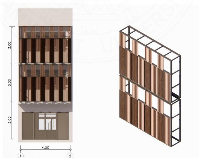
ภาพที่ 5.61 เปลือกอาคารรูปแบบที่ 2 ระแนงไม้สังเคราะห์ Wood Plastic Composite อาคารหลังที่ 3. โดยผู้วิจัย, 2567.
