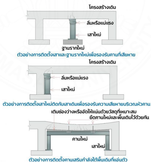
ภาพที่ 2.21 การเสริมกำลังโดยการเพิ่มโครงสร้าง. จาก เอกรินทร์ พันธุ์นิล, 2567.
