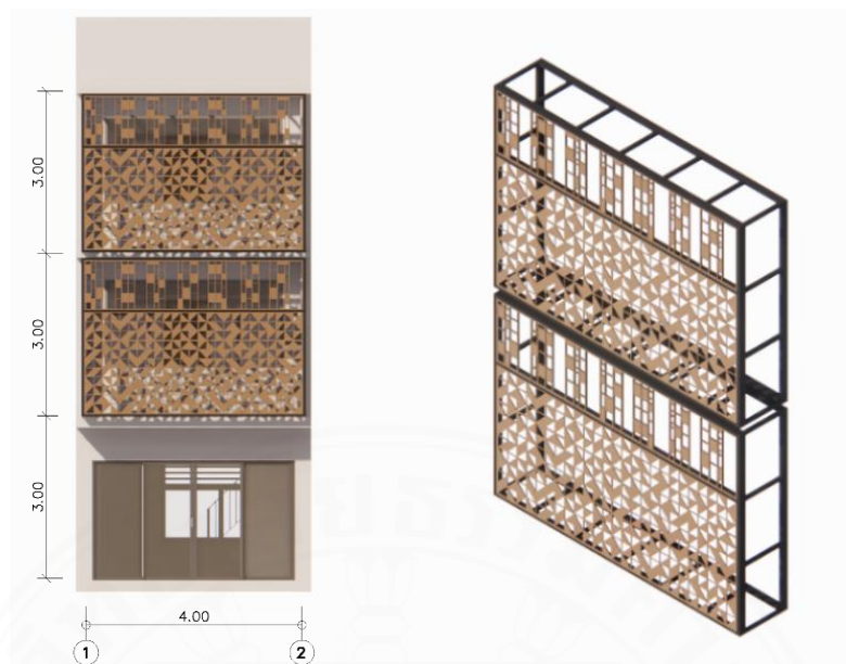
ภาพที่ 5.62 เปลือกอาคารรูปแบบที่ 3 อลูมิเนียมคอมโพสิตฉลุลาย อาคารหลังที่ 3. โดยผู้วิจัย, 2567.
