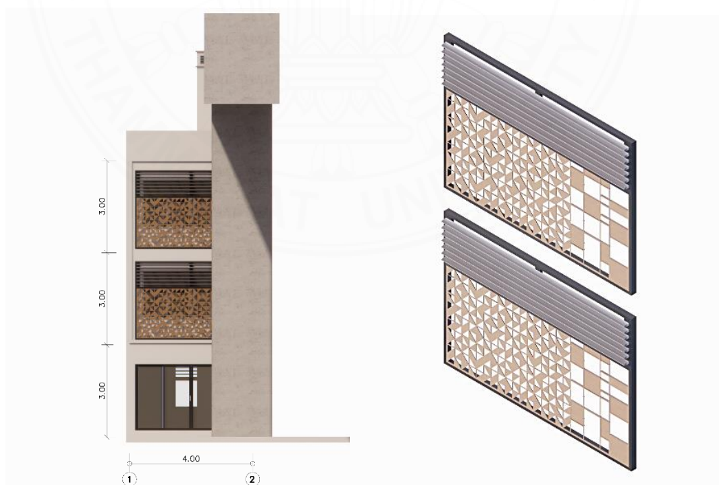
ภาพที่ 5.84 เปลือกอาคารรูปแบบที่ 3 อลูมิเนียมคอมโพสิตฉลุลาย อาคารหลังที่ 4. โดยผู้วิจัย, 2567.
