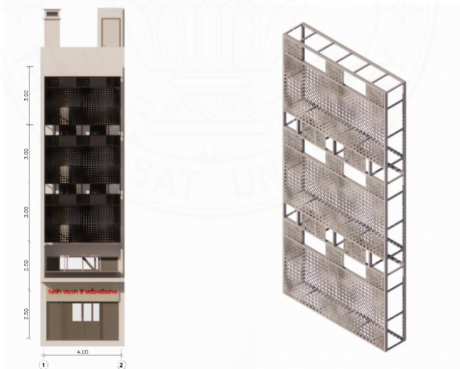
ภาพที่ 5.107 เปลือกอาคารรูปแบบที่ 5 อลูมิเนียมฉลุลาย อาคารหลังที่ 5. โดยผู้วิจัย, 2567.
