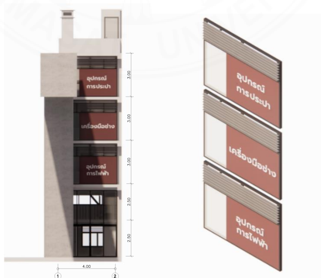
ภาพที่ 5.125 เปลือกอาคารรูปแบบที่ 1 ป้ายคอมโพสิต อาคารหลังที่ 6. โดยผู้วิจัย, 2567.
