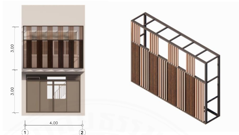
ภาพที่ 5.22 เปลือกอาคารรูปแบบที่ 2 ระแนงไม้สังเคราะห์ Wood Plastic Composite อาคารหลังที่ 1. โดยผู้วิจัย, 2567.
