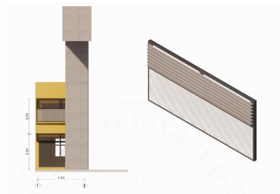
ภาพที่ 5.42 เปลือกอาคารรูปแบบที่ 4 ตะแกรงเหล็กฉีก อาคารหลังที่ 2. โดยผู้วิจัย, 2567.
