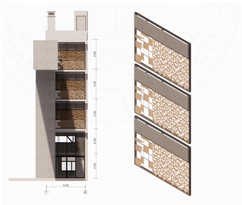
ภาพที่ 5.127 เปลือกอาคารรูปแบบที่ 3 อลูมิเนียมคอมโพสิตฉลุลาย อาคารหลังที่ 6. โดยผู้วิจัย, 2567.
