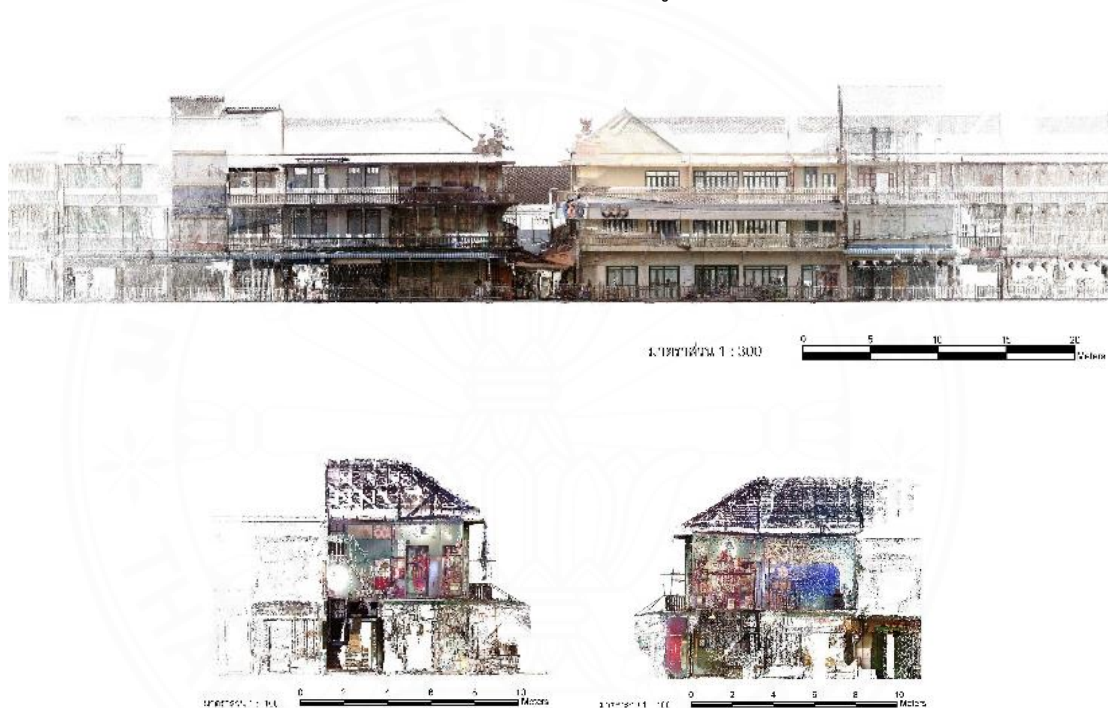
ภาพที่ 4.8 การเก็บข้อมูลตึกแถวร้อยปีเจริญไชยโดยใช้เครื่องเลเซอร์สแกน โดย บริษัทฟาโรเทคโนโลยีส์ (ประเทศไทย) จำกัด. ร่วมกับผู้วิจัย, 2567.
