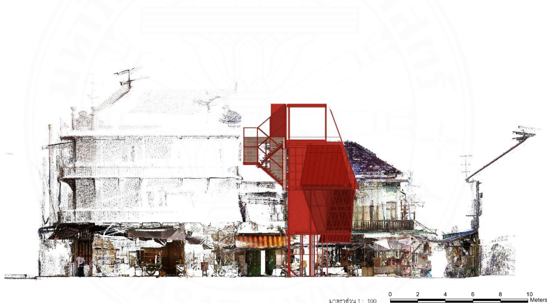
ภาพที่ 5.28 รูปด้าน B ผสานกับภาพ point cloud จากการเก็บข้อมูลผ่าน 3D Scan โดย บริษัทฟาโรเทคโนโลยีส์ (ประเทศไทย) จำกัด ร่วมกับผู้วิจัย, 2567.
