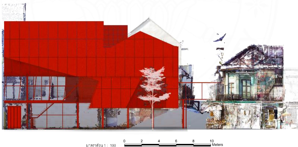
ภาพที่ 5.30 รูปด้าน A ผสานกับภาพ point cloud จากการเก็บข้อมูลผ่าน 3D Scan โดย บริษัทฟาโรเทคโนโลยีส์ (ประเทศไทย) จำกัด ร่วมกับผู้วิจัย, 2567.
