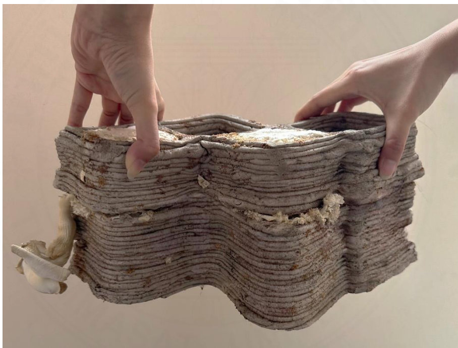
ภาพที่ 4.17 ผลลัพธ์การยึดติดระหว่างชิ้นงานด้วยไมซีเลียม. โดย ผู้วิจัย, 2567.
