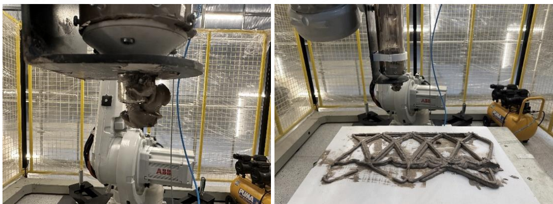
ภาพที่ 3.20 ภาพถ่ายการอุดตันของหัวฉีดและเส้นขึ้นงานขาดไม่ต่อเนื่อง โดย ผู้วิจัย, 2566.
