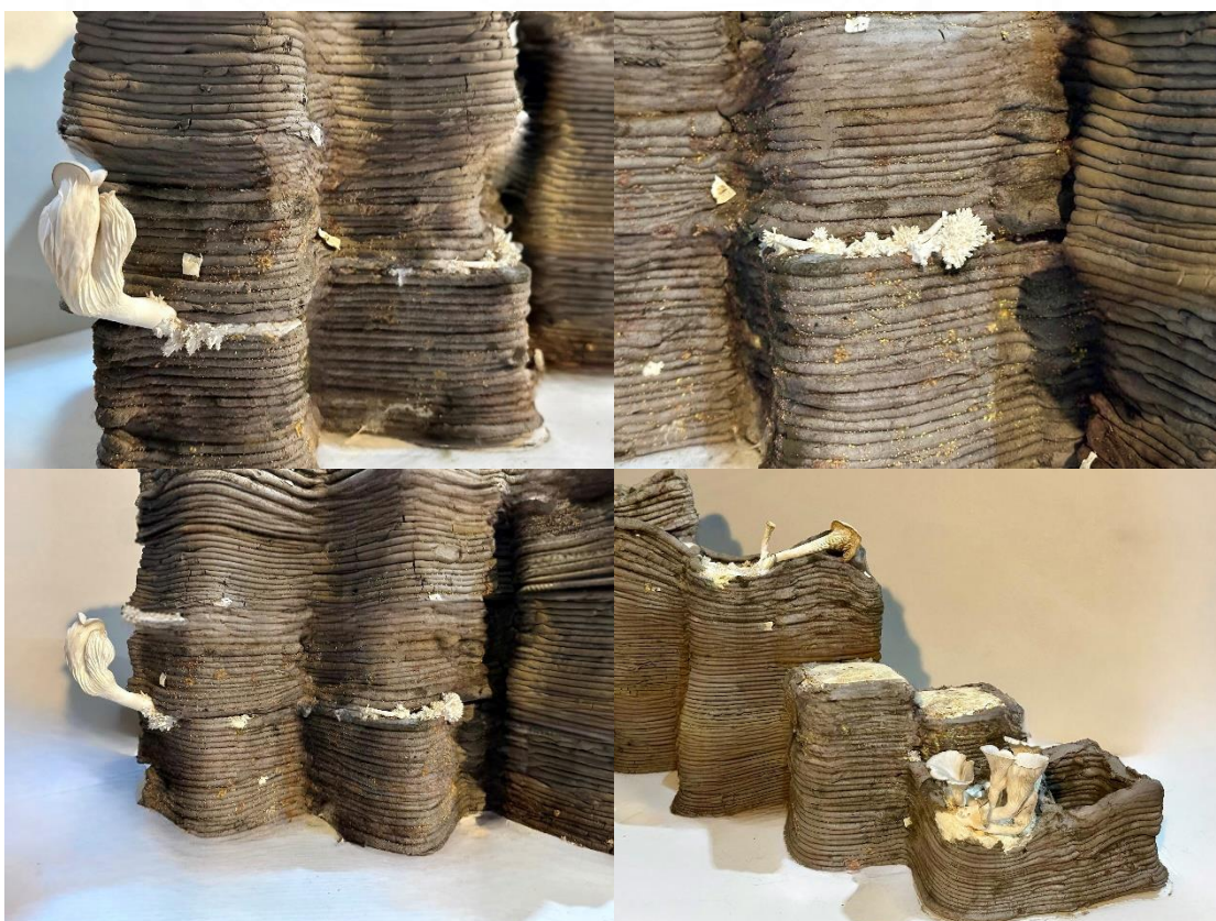
ภาพที่ 4.16 ผลลัพธ์การเติบโตของไมซีเลียมระหว่างชิ้นงานเมื่อผ่านไป 1 สัปดาห์. โดย ผู้วิจัย, 2567.
