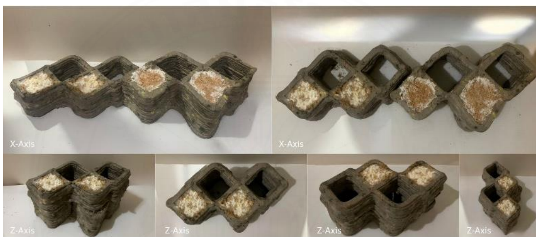
ภาพที่ 4.13 ภาพถ่ายการวางสองชิ้นงานชุดที่ 2 ในแต่ละแนวแกน. โดย ผู้วิจัย, 2567.
