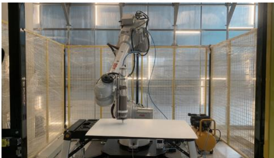
ภาพที่ 3.8 ภาพถ่ายเครื่องมือการพิมพ์สามมิติด้วยแขนหุ่นยนต์พร้อมวัสดุ. โดย ผู้วิจัย, 2566.
