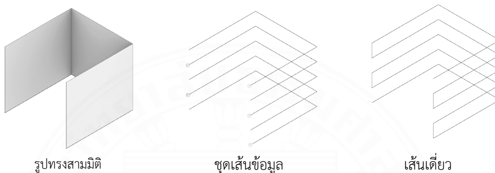
ภาพที่ 3.23 การแปลงรูปทรงสามมิติเป็นเส้นการเคลื่อนที่แบบเส้นเดี่ยว. โดย ผู้วิจัย, 2567.
