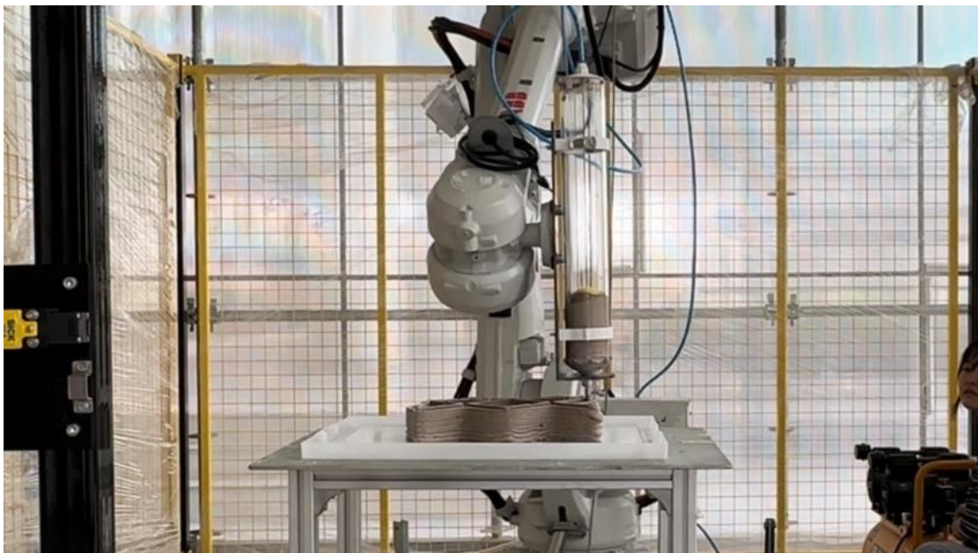
ภาพที่ 3.24 ภาพถ่ายการพิมพ์สามมิติวัสดุไมซีเลียมคอมโพสิตด้วยแขนหุ่นยนต์. โดย ผู้วิจัย, 2567.
