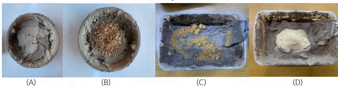
ภาพที่ 3.2 ภาพ (A) หัวเชื้อเห็ดในวุ้น PDA ผสมรวมกับดินเหนียว. ภาพ (B) หัวเชื้อเห็ดในเมล็ดข้าวฟ่างผสมรวมกับดินเหนียว. ภาพ (C) ก้อนเชื้อเห็ดปั้นผงผสมรวมกับดินเหนียว. ภาพ (D) เชื้อเห็ดโตเต็มที่ปั้นผงผสมรวมกับดินเหนียว. โดย ผู้วิจัย, 2566.
