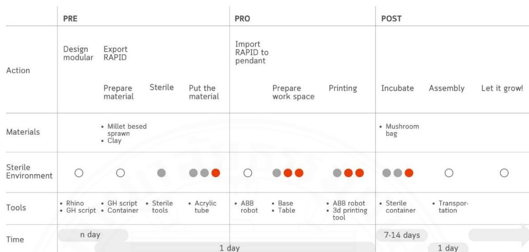
ภาพที่ 5.2 ภาพขั้นตอนการก่อสร้างสถาปัตยกรรมจากวัสดุไมซีเลียมคอมโพสิต โดยใช้เทคโนโลยีการพิมพ์สามมิติด้วยแขนหุ่นยนต์. โดย ผู้วิจัย, 2567.
