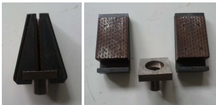
ภาพที่ 3.8 หัวทดสอบที่ใช้สำหรับการทดสอบกำลังต้านทานแรงดึงขนานเสี้ยน
