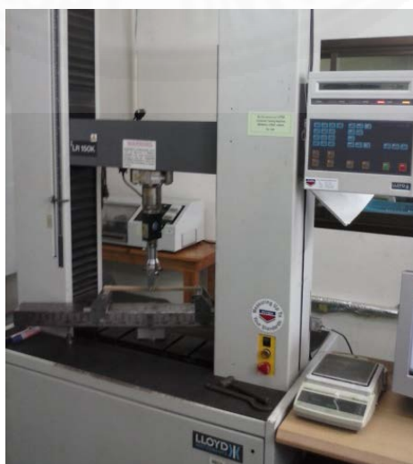
ภาพที่ 3.4 เครื่องทดสอบสากล (Universal testing machine) ยี่ห้อ Lloyd Model 150 kN
