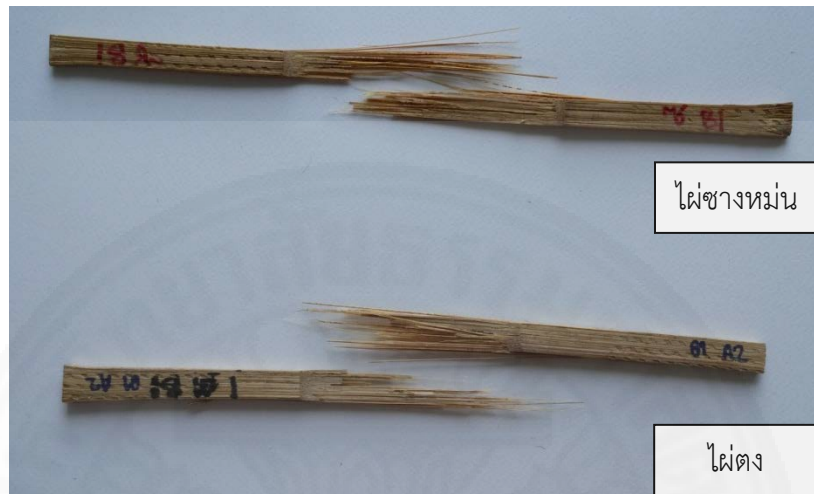
ภาพที่ 4.26 ลักษณะการเสียรูปของชิ้นตัวอย่างทดสอบกำลังต้านทานแรงดึงขนานเส้นของไม้
