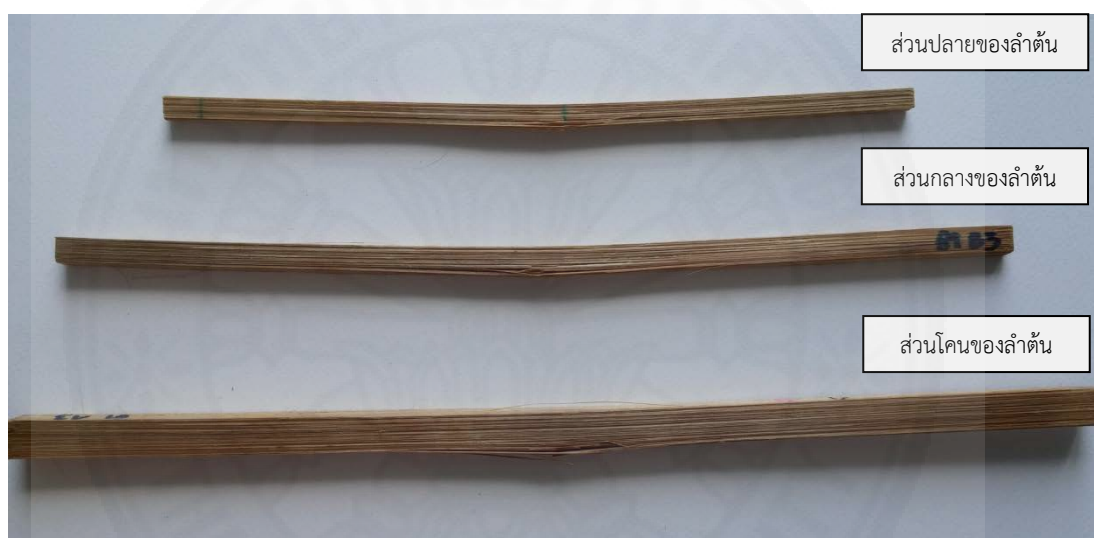
ภาพที่ 4.9 ลักษณะการเสียรูปของขึ้นตัวอย่างทดสอบกำลังต้านทานแรงดัดของไม้ต่ง
