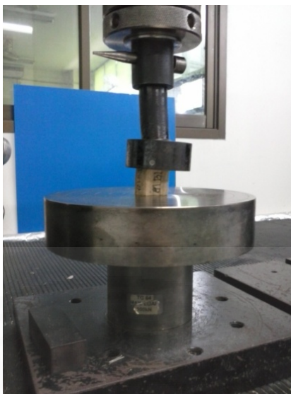
ภาพที่ 3.16 การทดสอบกำลังต้านทานแรงอัดขนานเสี้ยน
