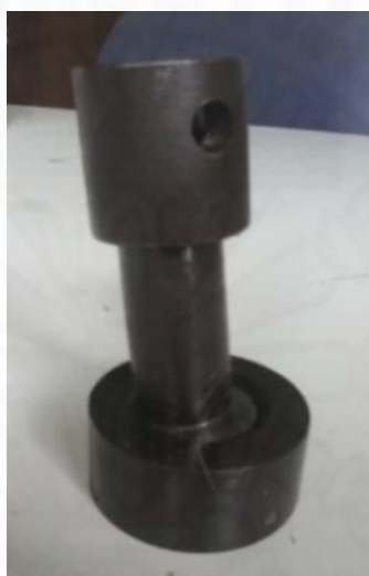
ภาพที่ 3.6 หัวทดสอบที่ใช้สำหรับการทดสอบกำลังต้านทานแรงอัดขนานเสี้ยนและกำลังต้านทานแรงอัดตั้งฉากเสี้ยน
