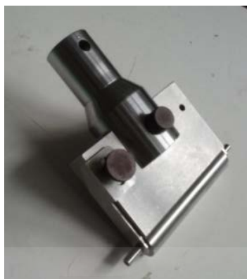
ภาพที่ 3.5 หัวทดสอบที่ใช้สำหรับการทดสอบกำลังต้านทานแรงดัด
