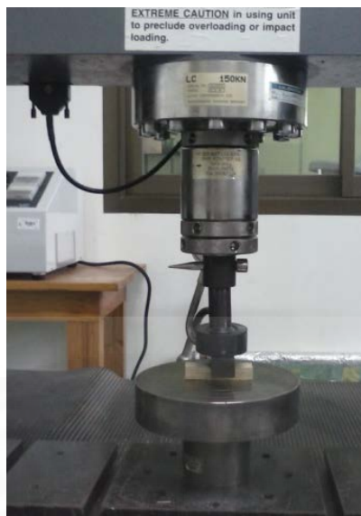
ภาพที่ 3.17 การทดสอบกำลังต้านทานแรงอัดตั้งฉากเสี้ยน
