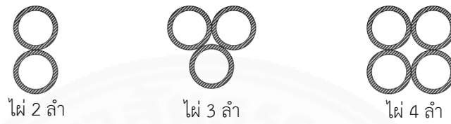
ภาพที่ 4.34 รูปแบบหน้าตัดของการรวบไฟ 2 ลำ, 3 ลำ และ 4 ลำ
