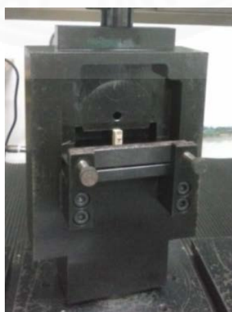
ภาพที่ 3.7 หัวทดสอบที่ใช้สำหรับการทดสอบกำลังต้านทานแรงเฉือนขนานเสี้ยน
