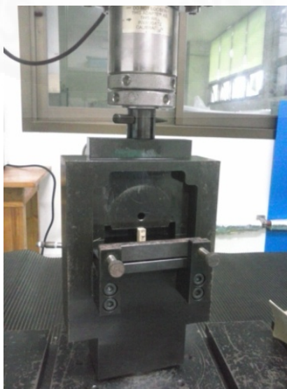
ภาพที่ 3.18 การทดสอบกำลังต้านทานแรงเฉือนขนานเสี้ยน
