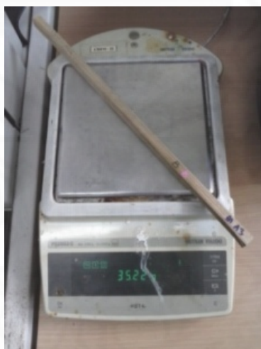
ภาพที่ 3.1 เครื่องชั่งน้ำหนักดิจิทัล ยี่ห้อ METTLER TOLEDO รุ่น PG2002-S
