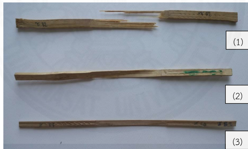
ภาพที่ 4.27 ลักษณะของชิ้นตัวอย่างทดสอบกำลังต้านทานแรงดึงขนานเส้นของไม้ที่เกิดการฉีกขาดหรือรูดหลุดบริเวณที่จับก่อนจะถึงจุดวิบัติ
