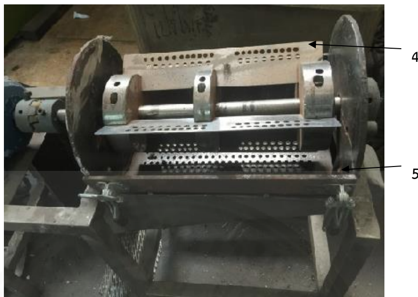
ภาพที่ 6.2 เครื่องกะเทาะมะขามแบบตี (แสดงชิ้นส่วนภายใน)
