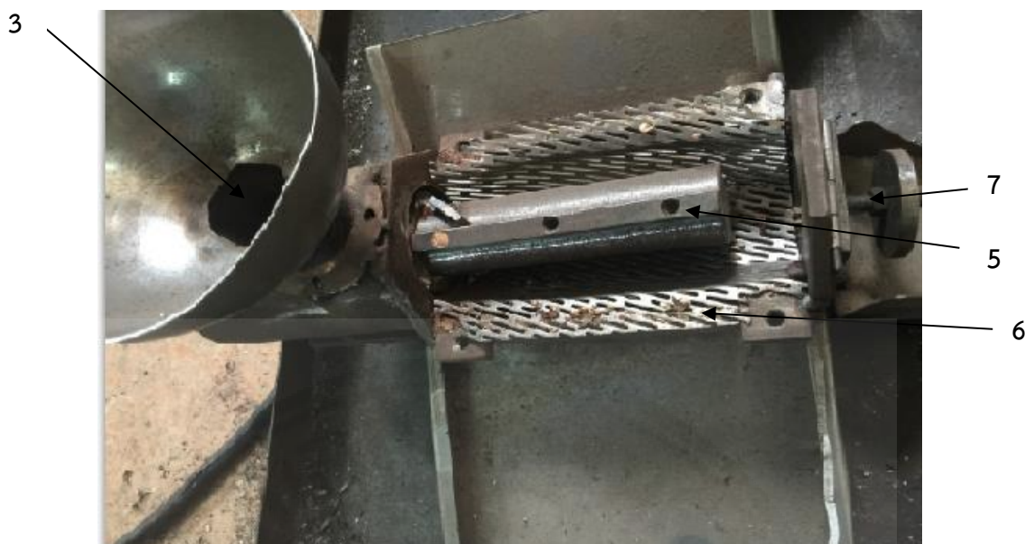
ภาพที่ 6.7 ส่วนประกอบของแกนเหล็กกะเทาะเม็ลต์มะขาม
