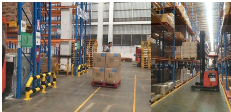
ภาพที่ 2.16 การจัดเก็บสินค้าโดยใช้รถประเภท Power Pallet Truck และ Reach Truck. จาก หน่วยงานความปลอดภัยและสิ่งแวดล้อม บริษัท โลจิสติกส์ ก.
