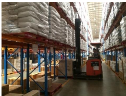
ภาพที่ 2.17 การใช้รถยกประเภท Reach Truck ในการเติมเต็มสินค้า. จาก หน่วยงานความปลอดภัยและสิ่งแวดล้อม บริษัท โลจิสติกส์ ก.
