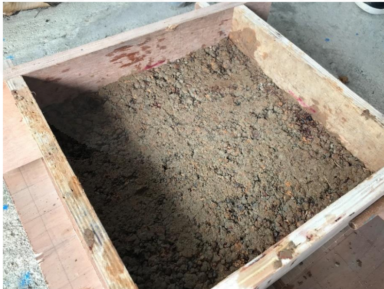
ภาพที่ 12 แสดงการเตรียมตัวอย่างสำหรับการทดสอบความเสียดทานของผิวทาง
