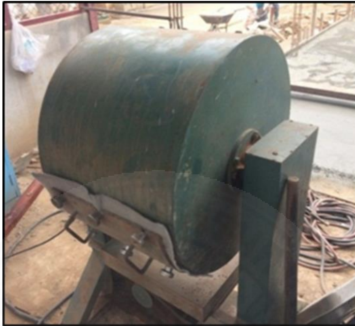
ภาพที่ 5 แสดงอุปกรณ์การทดสอบหาความสึกหรอของวัสดุชนิดเม็ดหยาบ (Coarse aggregates) ตามมาตรฐานการทดลองที่ มทช.(ท) 501.9-2545
