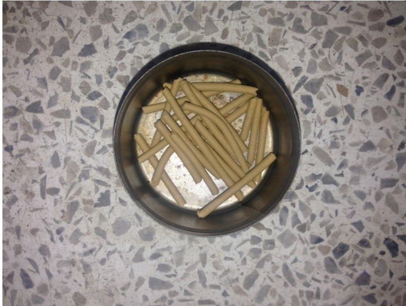
ภาพที่ 3 แสดงการทดสอบเพื่อหาค่าขีดพลาสติก (Plastic limit : PL) ตามมาตรฐานการทดลองที่ มทช.(ท) 501.6-2545
