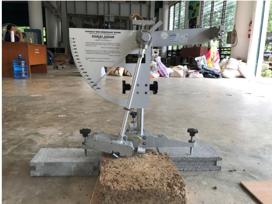
ภาพที่ 13 แสดงการทดสอบความเสียดทานผิวทางแบบผิวแห้ง
