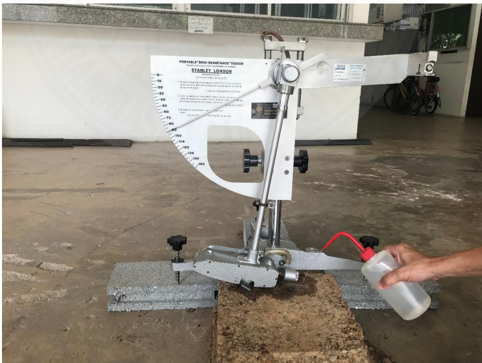
ภาพที่ 14 แสดงการทดสอบความเสียดทานผิวทางแบบผิวเปียก
