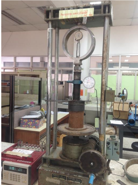
ภาพที่ 11 การทดสอบการรับแรงอัดแกนเดียว (Unconfined compression test, q_u )
