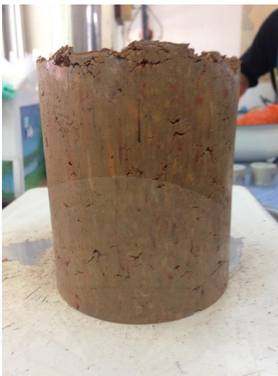
ภาพที่ 9 แสดงตัวอย่างแท่งบดอัดสำหรับการทดสอบการรับแรงอัดแกนเดียว
