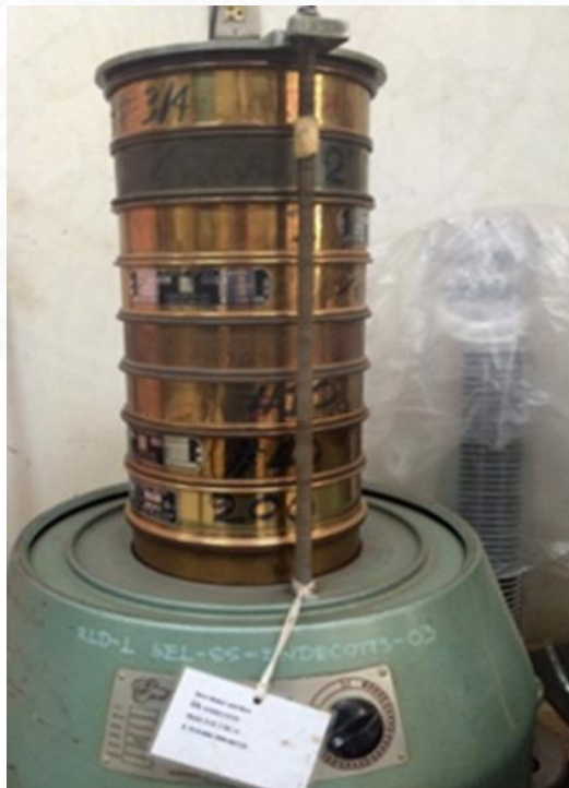
ภาพที่ 4 แสดงอุปกรณ์การทดสอบหาขนาดเม็ดของวัสดุ (Sieve analysis) ตามมาตรฐานการทดลองที่ มทช.(ท) 501.8-2545
