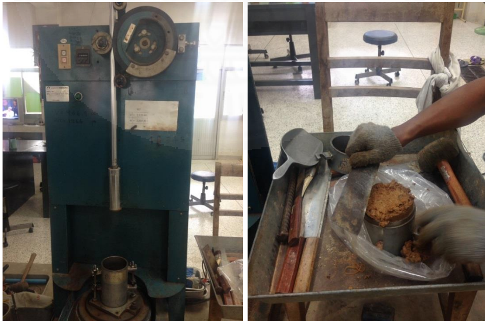
ภาพที่ 6 การทดสอบความแน่นแบบสูงกว่ามาตรฐาน (MODIFIED COMPACTION TEST) ตามมาตรฐานการทดลองที่ มทช.(ท) 501.2-2545
