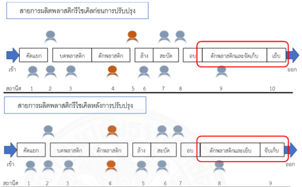
ภาพที่ 3.30 การยุบสถานีที่ 4 สถานีที่ 5 และการสลับสถานีงานย่อย
