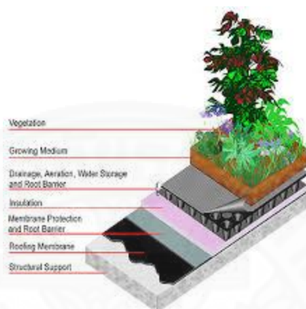
ภาพที่ 2.1 ตัวอย่างส่วนประกอบของ Green Roof
