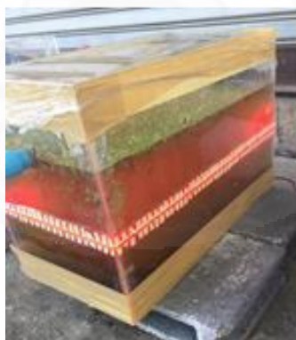
ภาพที่ 3.3 บ่อบำบัดจำลองติดตั้งหลอดไฟแอลอีดีสีแดง
